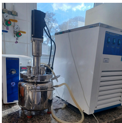
Figura 9 - Sistema montado para realização da hidrólise enzimática.
