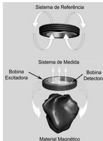
Figura 2: Esquema de funcionamento do sistema BAC - ilustração do funcionamento do monossensor.
