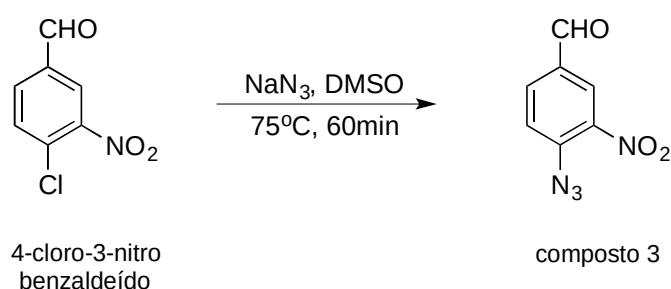
Figura 20 - Obtenção do derivado 3, 4-azida-3nitrobenzaldeído (composto 3).
