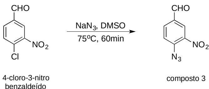
Figura 10 - Obtenção do derivado 3, 4-azida-3nitrobenzaldeído.
