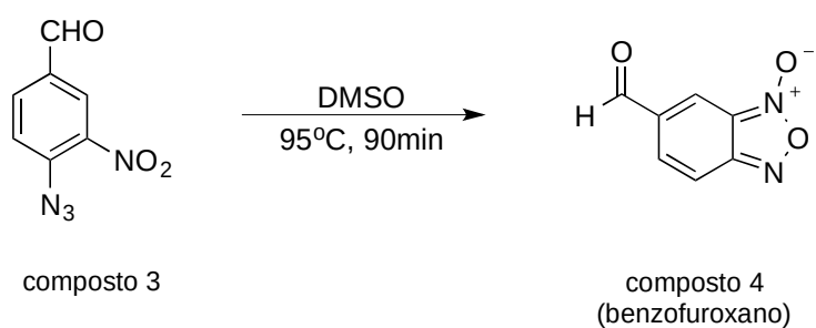
Figura 22 - Obtenção do derivado 4, 6-formilbenzo[c]-N-óxido-1,2,5-oxadiazol (benzofuroxano/ composto 4).
