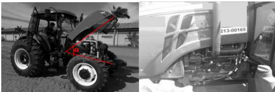
Figura 2. a) Medições para altura de abertura, comprimento e ângulo de abertura do capô e componentes visíveis com capô; b) componentes visíveis com capô fechado.
