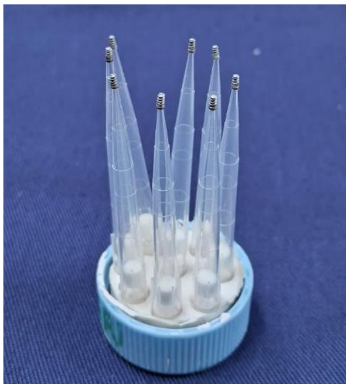
Figura 2 – Implantes estabilizados em aparato a base de alginato prontos para receberem a funcionalização de superfície
