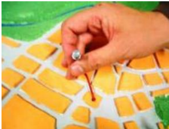
Figura 18: Sensor de toque na maquete
