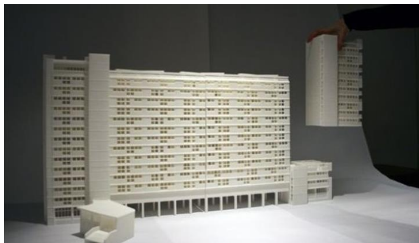
Figura 17: Maquete feita com impressora 3D por arquiteto
