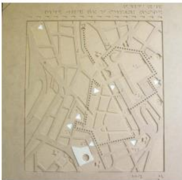
Figura 8: Matriz em negativo produzida em madeira na roteadora
