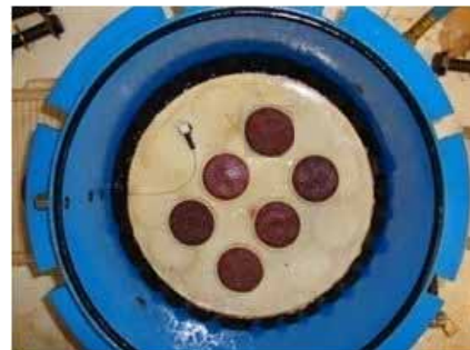
Figura 4. Detalhes dos constituintes da câmara de pressão de Richards (a) (adaptado de LIBARDI, 2005) e amostras deformadas de solo no interior da câmara de pressão de Richards com placa porosa (b).
