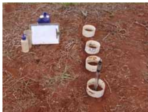
Figura 1. Partes constituintes do infiltrômetro (a) e detalhe do cilindro de polietileno e do infiltrômetro no campo (b).
