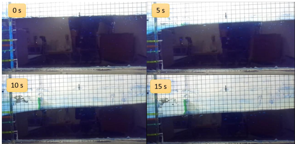
Figura 10 – Variação do nível do gel de carbopol dentro do reservatório em relação ao tempo para fluido C0_17, mesa com 2° de inclinação, Caso 1
