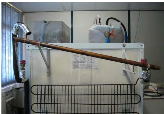
Figura 3.4 - Trocador de calor de tubos concêntricos sem isolamento.
