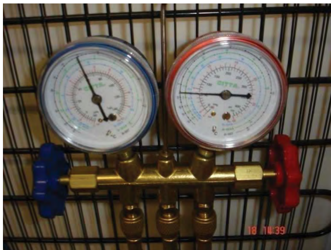
Figura 3.8 - Manômetro Bourbon utilizado para medidas de pressão.
