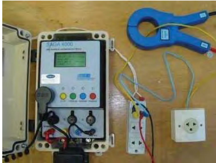
Figura 3.12 - Registrador de grandezas elétricas.
