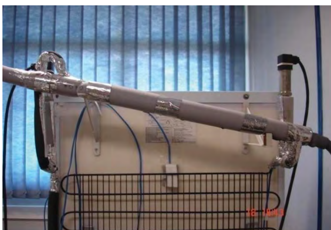
Figura 3.5 - Trocador de calor de tubos concêntricos isolado termicamente.
