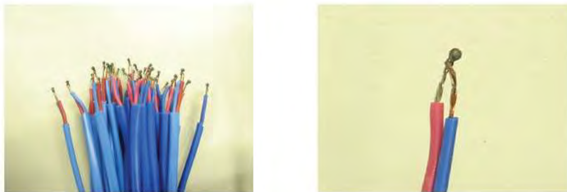
Figura 3.17 - Termopares tipo “T” (cobre-constantan).
