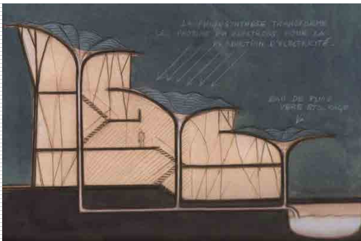
Esquema de captação de água e energia solar- SCHUITEN, Luc. Vers Une Cité Végétale. 2010.
