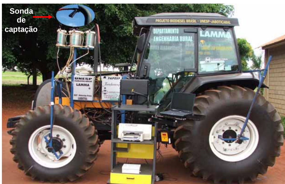
Figura 7. Vista geral do trator instrumentado para o ensaio de opacidade da fumaça (LOPES, 2006).
