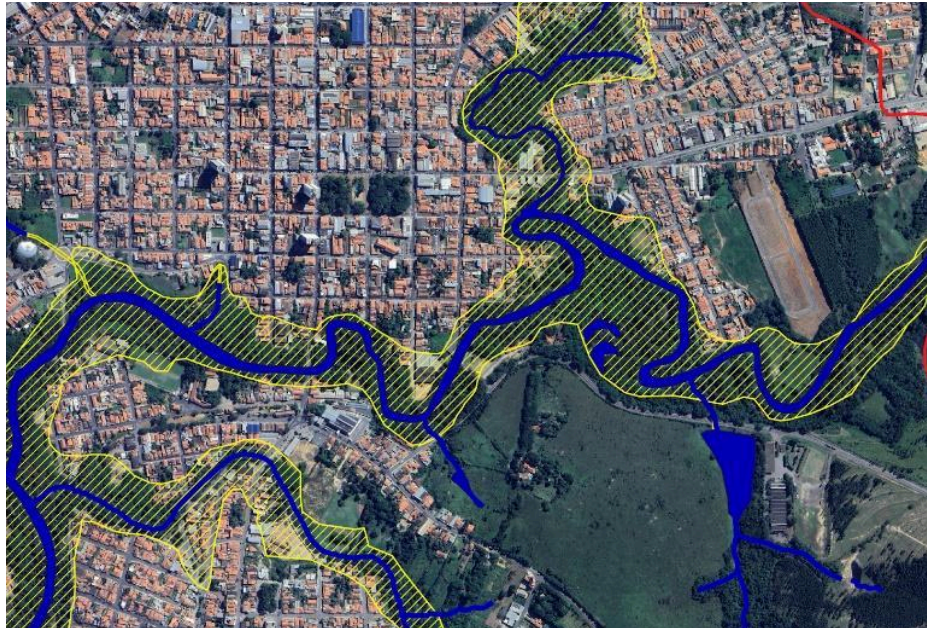
Figura 72. Áreas de inundação no centro da cidade
