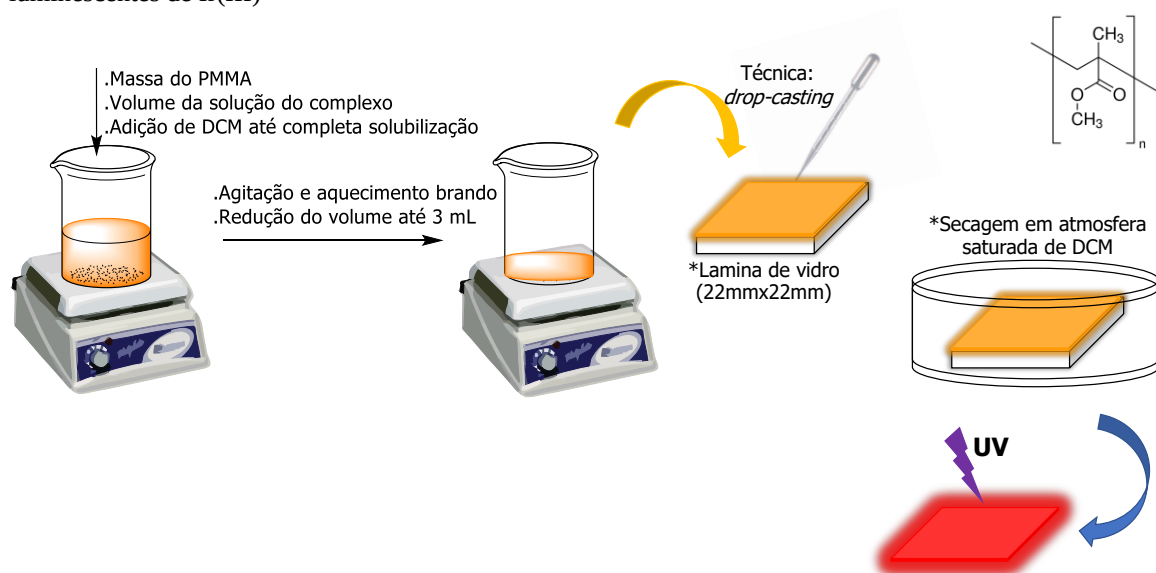
Figura 66: Esquema de fabricação dos filmes de PMMA variando a concentração de complexos luminescentes de Ir(III)
