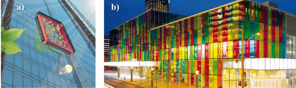
Figura 6: Aproveitamento da radiação solar em janelas prediais com o uso de LSCs acoplados em células fotovoltaicas, (a). Janelas coloridas do centro de convenções Palais des Congress, (b).
