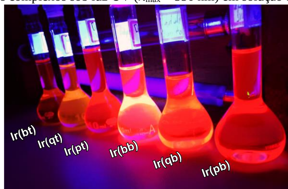
Figura 51: Fotografia dos complexos sob luz UV ( \lambda_{\text{máx}} = 350 \text{ nm} ) em solução de DMSO 1,0 \times 10^{-4} \text{ mol} \cdot \text{L}^{-1} .
