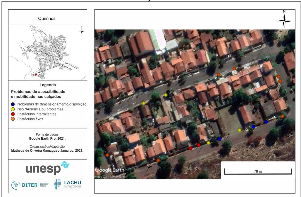
A figura 42 apresenta problemas nas calçadas como os de dimensionamento e ausência de piso, além dos obstáculos fixos e intermitentes.
