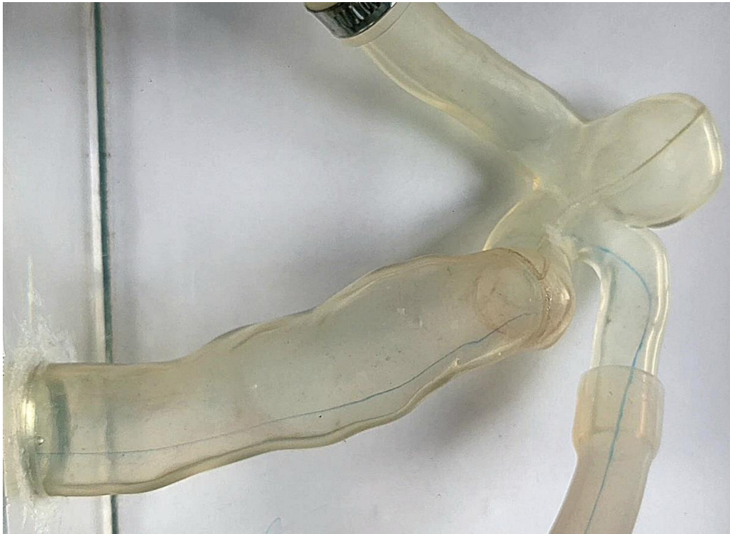
Figura 16: Linha de emissão observada com injeção de corante na direita da entrada do escoamento (posição 3) – vista superior, Re = 199 .
