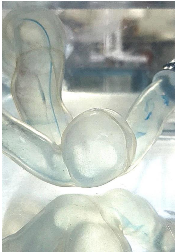
Figura 50: Linha de emissão observada com injeção de corante na parte superior da entrada do escoamento (posição 4) – vista frontal, Re = 644 .
