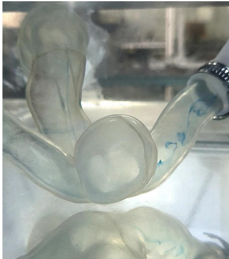
Figura 44: Linha de emissão observada com injeção de corante na esquerda da entrada do escoamento (posição 2) – vista frontal, Re = 644 .
