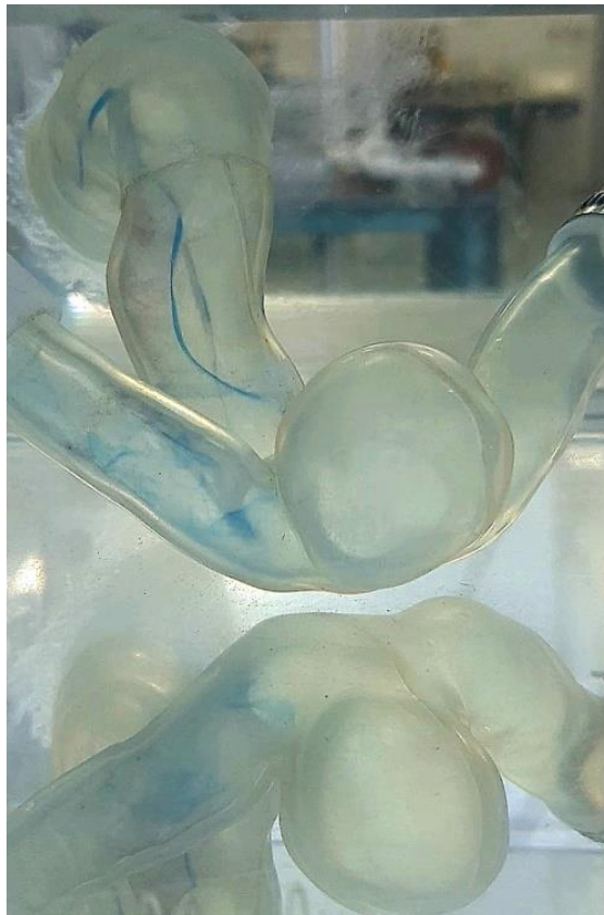
Figura 47: Linha de emissão observada com injeção de corante na direita da entrada do escoamento (posição 3) – vista frontal, Re = 644 .
