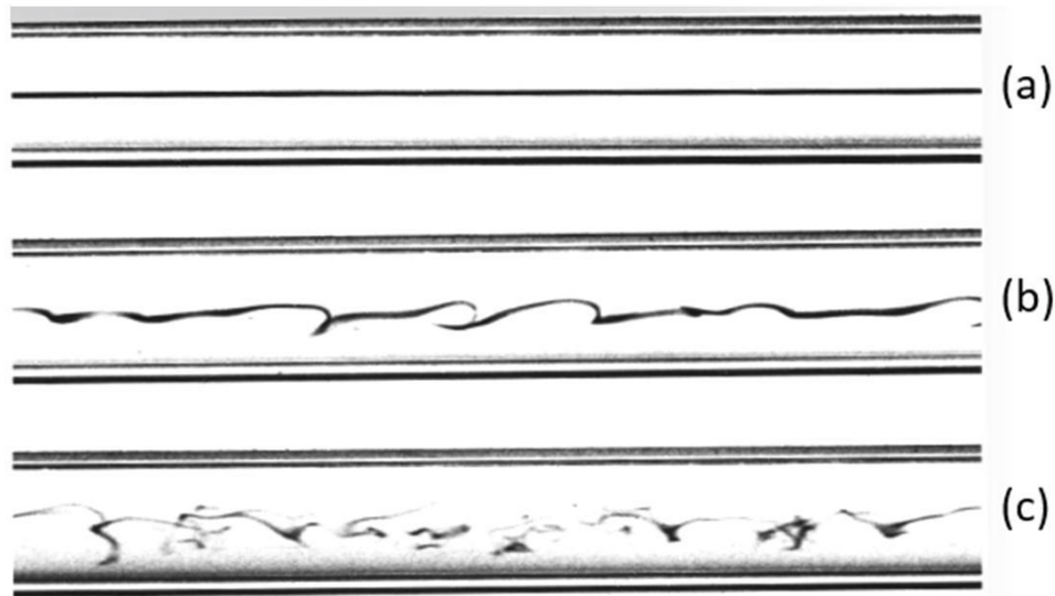
Figura 4: Visualização da transição entre regimes de um escoamento através do método de injeção de corante líquido: (a) Regime laminar (b) Regime de transição (c) Regime turbulento.
