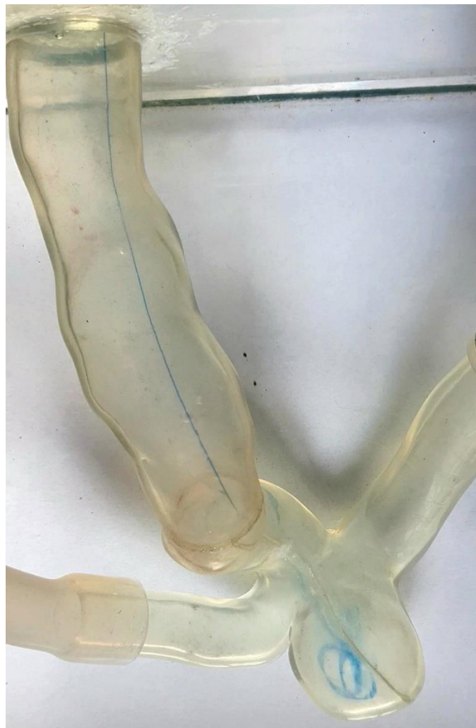
Figura 13: Linha de emissão observada com injeção de corante na esquerda da entrada do escoamento (posição 2) – vista superior Re = 199 .
