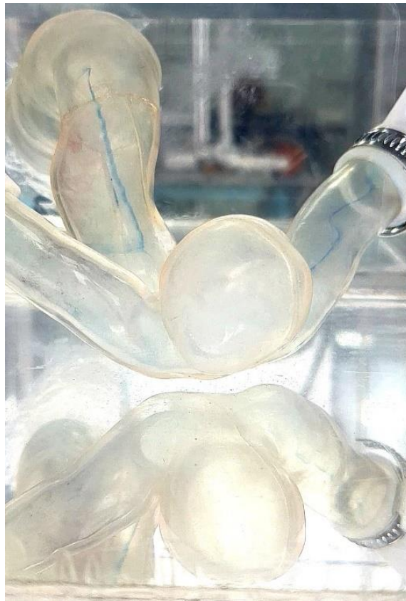
Figura 35: Linha de emissão observada com injeção de corante na parte superior da entrada do escoamento (posição 4) – vista frontal, Re = 389 .
