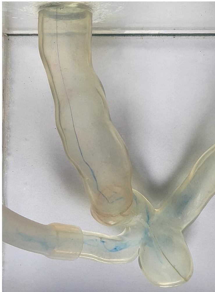
Figura 31: Linha de emissão observada com injeção de corante na direita da entrada do escoamento (posição 3) – vista superior, Re = 389 .
