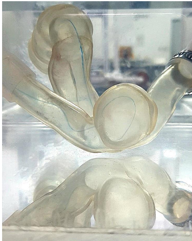
Figura 20: Linha de emissão observada com injeção de corante na parte superior da entrada do escoamento (posição 4) – vista frontal, Re = 199 .
