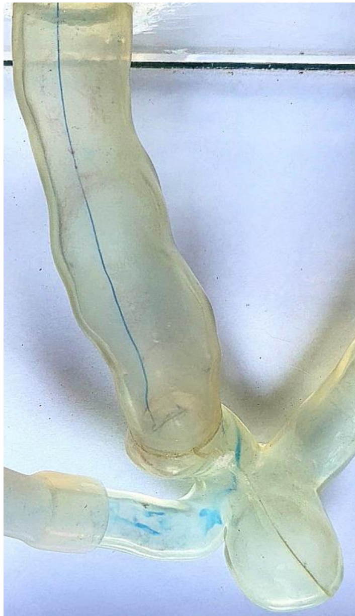
Figura 46: Linha de emissão observada com injeção de corante na direita da entrada do escoamento (posição 3) – vista superior, Re = 644 .
