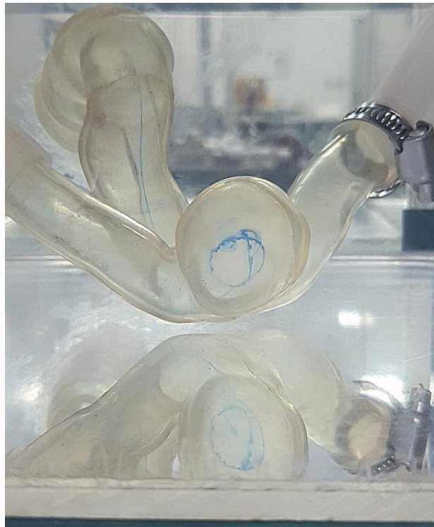
Figura 23: Linha de emissão observada com injeção de corante na parte inferior da entrada do escoamento (posição 5) – vista frontal, Re = 199 .
