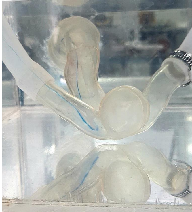
Figura 17: Linha de emissão observada com injeção de corante na direita da entrada do escoamento (posição 3) – vista frontal, Re = 199 .
