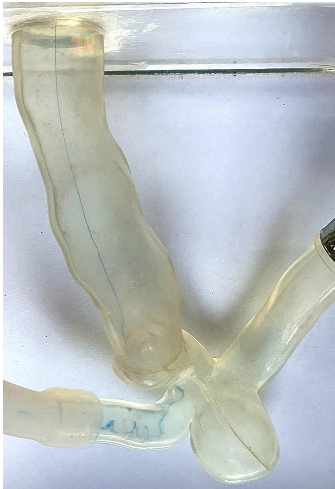
Figura 40: Linha de emissão observada com injeção de corante no centro da entrada do escoamento (posição 1) – vista superior, Re = 644 .
