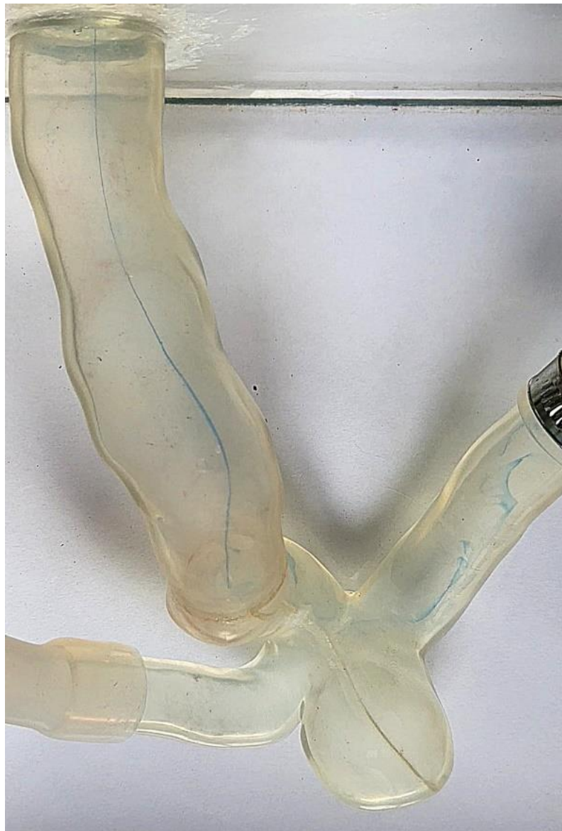
Figura 37: Linha de emissão observada com injeção de corante na parte inferior da entrada do escoamento (posição 5) – vista superior, Re = 389 .
