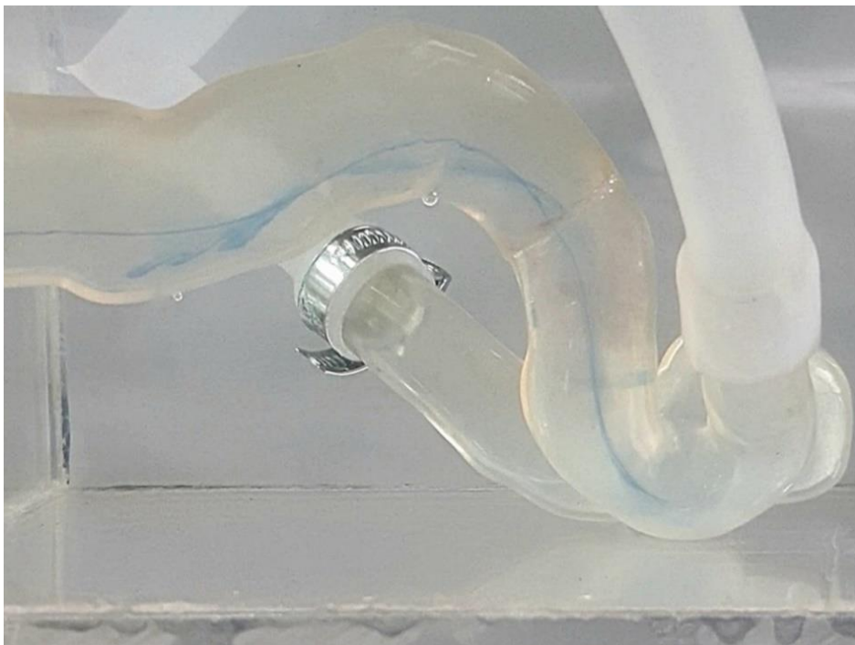
Figura 24: Linha de emissão observada com injeção de corante na parte inferior da entrada do escoamento (posição 5) – vista lateral, Re = 199 .
