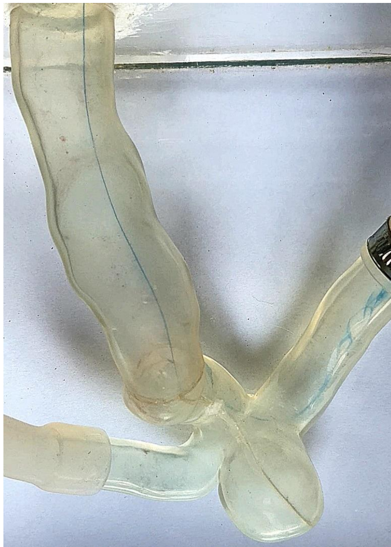
Figura 43: Linha de emissão observada com injeção de corante na esquerda da entrada do escoamento (posição 2) – vista superior, Re = 644 .
