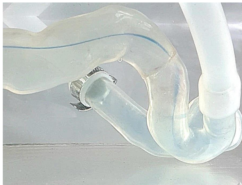
Figura 51: Linha de emissão observada com injeção de corante na parte superior da entrada do escoamento (posição 4) – vista lateral, Re = 644 .
