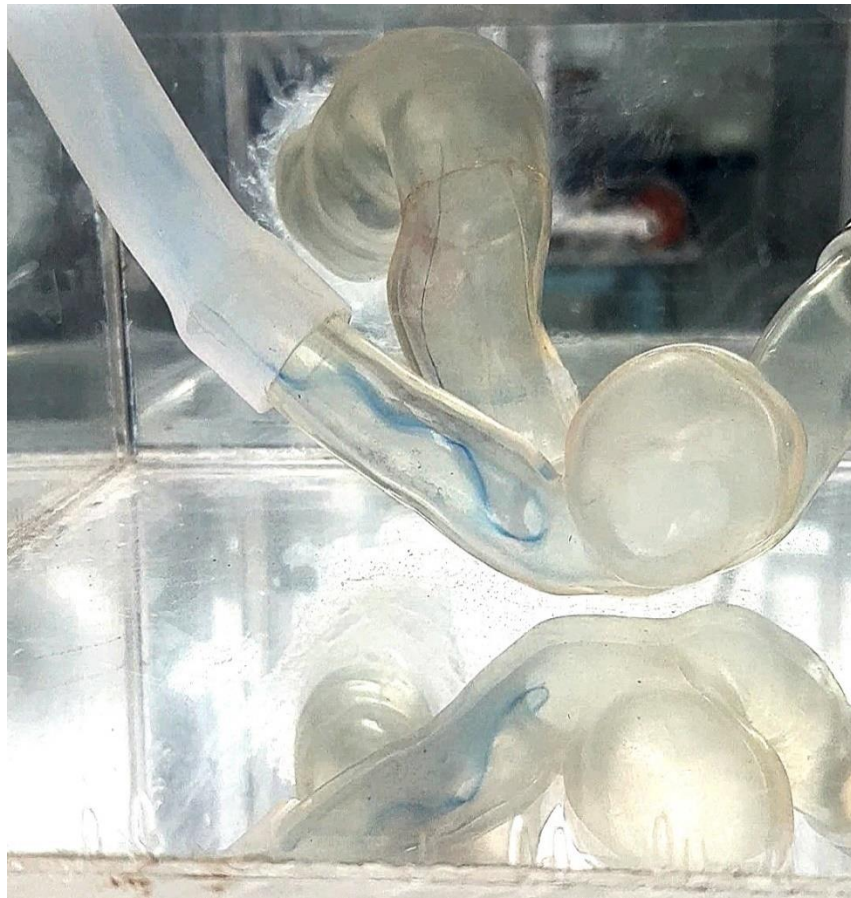
Figura 26: Linha de emissão observada com injeção de corante no centro da entrada do escoamento (posição 1) – vista frontal, Re = 389 .
