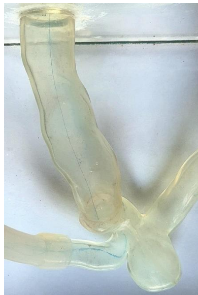
Figura 11: Linha de emissão observada com injeção de corante no centro da entrada do escoamento (posição 1) – vista superior, Re = 199 .
