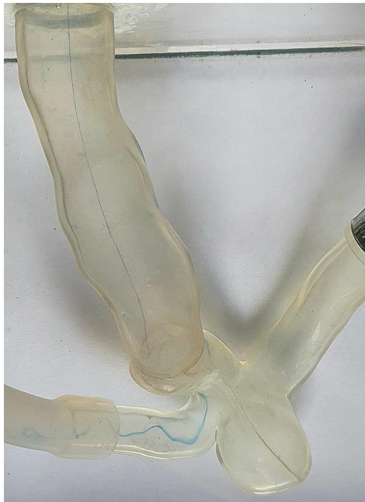
Figura 25: Linha de emissão observada com injeção de corante no centro da entrada do escoamento (posição 1) – vista superior, Re = 389 .
