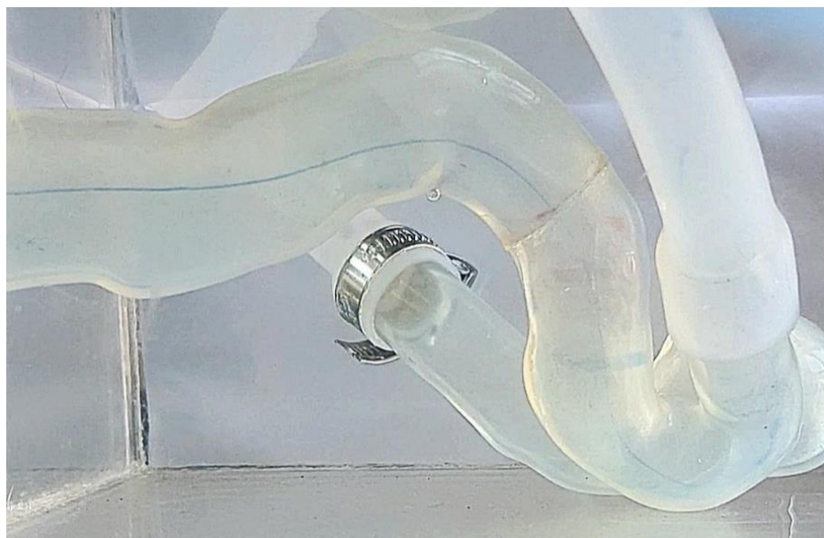
Figura 42: Linha de emissão observada com injeção de corante no centro da entrada do escoamento (posição 1) – vista lateral, Re = 644 .
