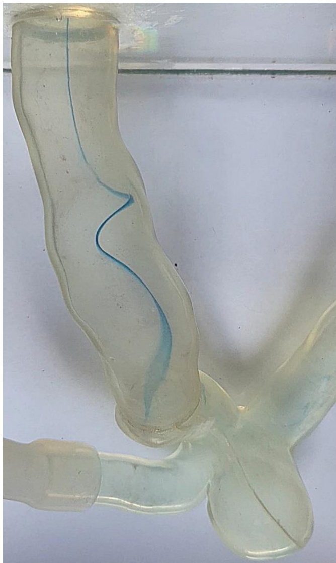
Figura 52: Linha de emissão observada com injeção de corante na parte inferior da entrada do escoamento (posição 5) – vista superior, Re = 644 .
