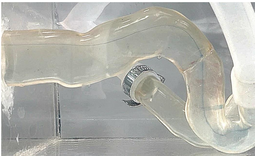
Figura 21: Linha de emissão observada com injeção de corante na parte superior da entrada do escoamento (posição 4) – vista lateral, Re = 199 .
