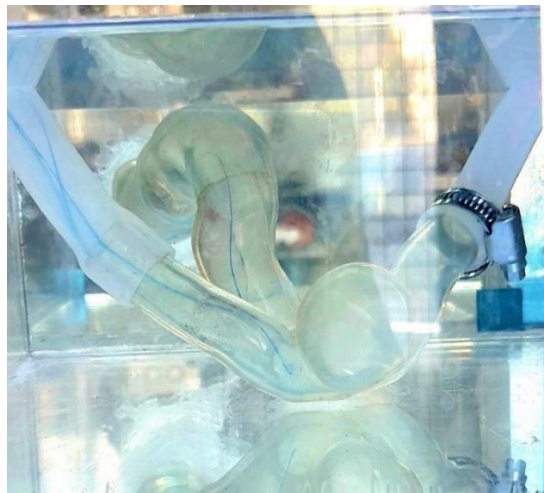
Figura 12: Linha de emissão observada com injeção de corante no centro da entrada do escoamento (posição 1) – vista frontal, Re = 199 .
