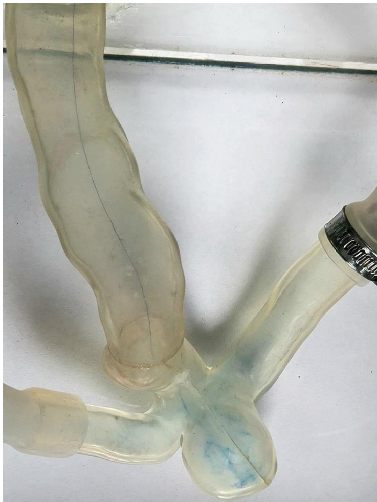
Figura 28: Linha de emissão observada com injeção de corante na esquerda da entrada do escoamento (posição 2) – vista superior, Re = 389 .
