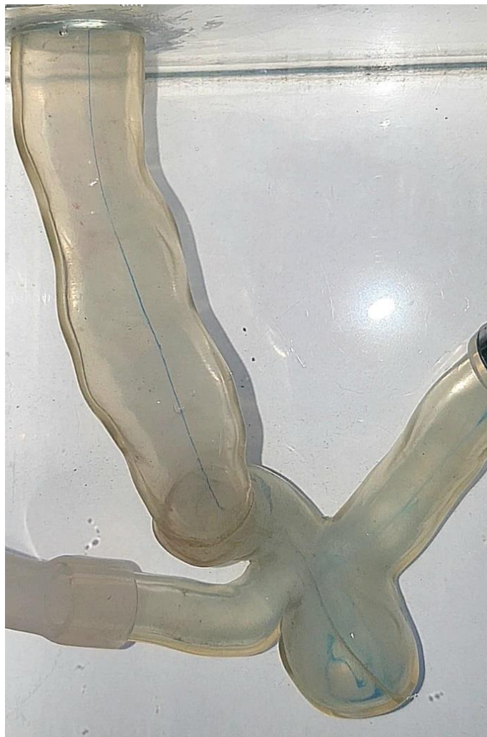
Figura 22: Linha de emissão observada com injeção de corante na parte inferior da entrada do escoamento (posição 5) – vista superior, Re = 199 .
