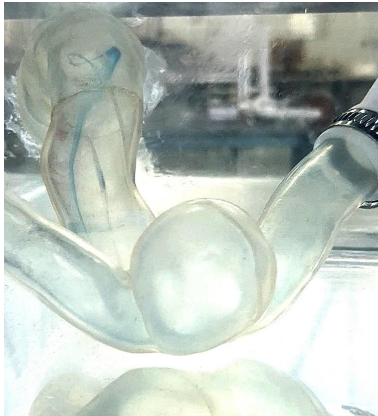
Figura 53: Linha de emissão observada com injeção de corante na parte inferior da entrada do escoamento (posição 5) – vista frontal, Re = 644 .
