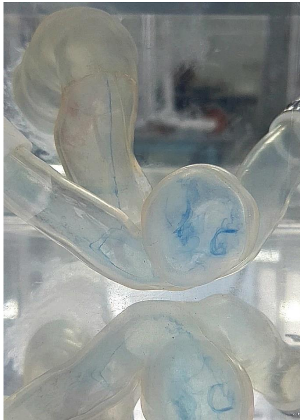
Figura 29: Linha de emissão observada com injeção de corante na esquerda da entrada do escoamento (posição 2) – vista frontal, Re = 389 .
