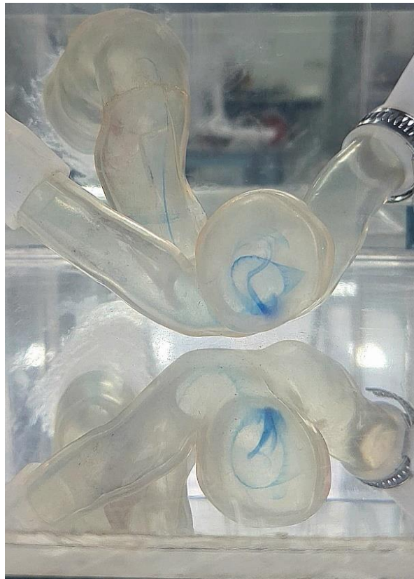
Figura 14: Linha de emissão observada com injeção de corante na esquerda da entrada do escoamento (posição 2) – vista frontal, Re = 199 .
