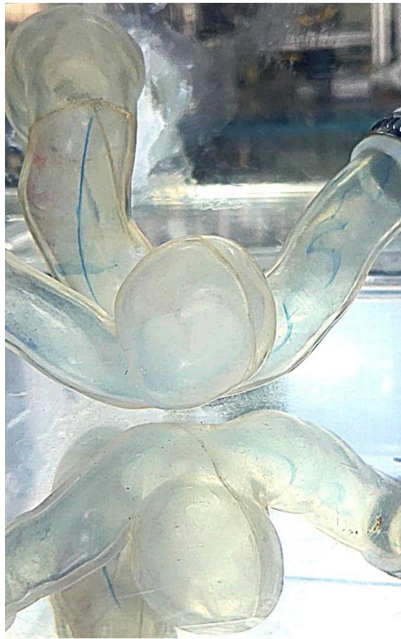
Figura 38: Linha de emissão observada com injeção de corante na parte inferior da entrada do escoamento (posição 5) – vista frontal, Re = 389 .
