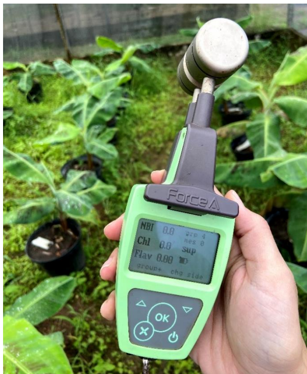
Figura 5. Determinação do teor de clorofila, flavonoides e índice nitrogênio nas folhas, foi utilizado para a leitura o equipamento Dualex. Registro/SP, 2020.
