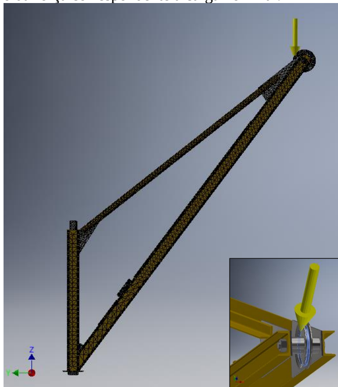
Figura 15 – Aplicação da força correspondente à carga nominal.
