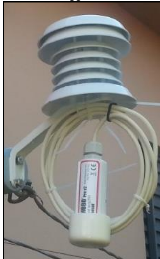
Figura 16 - Abrigo meteorológico (tipo RS3 - Hobo) com registrador de temperatura e umidade com sonda externa - data logger U23-002 - Hobo
