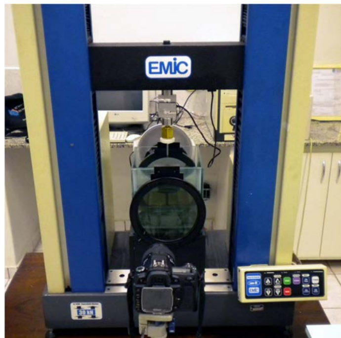
Figura 2 Polariscópio circular acoplado a uma máquina de ensaio universal (EMIC DL-3000)
