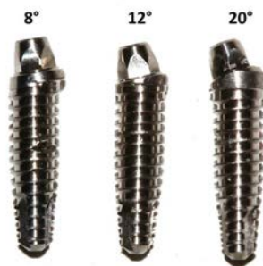
Figura 1 Três diferentes angulações no corpo do implante (8°, 12° e 20°)
