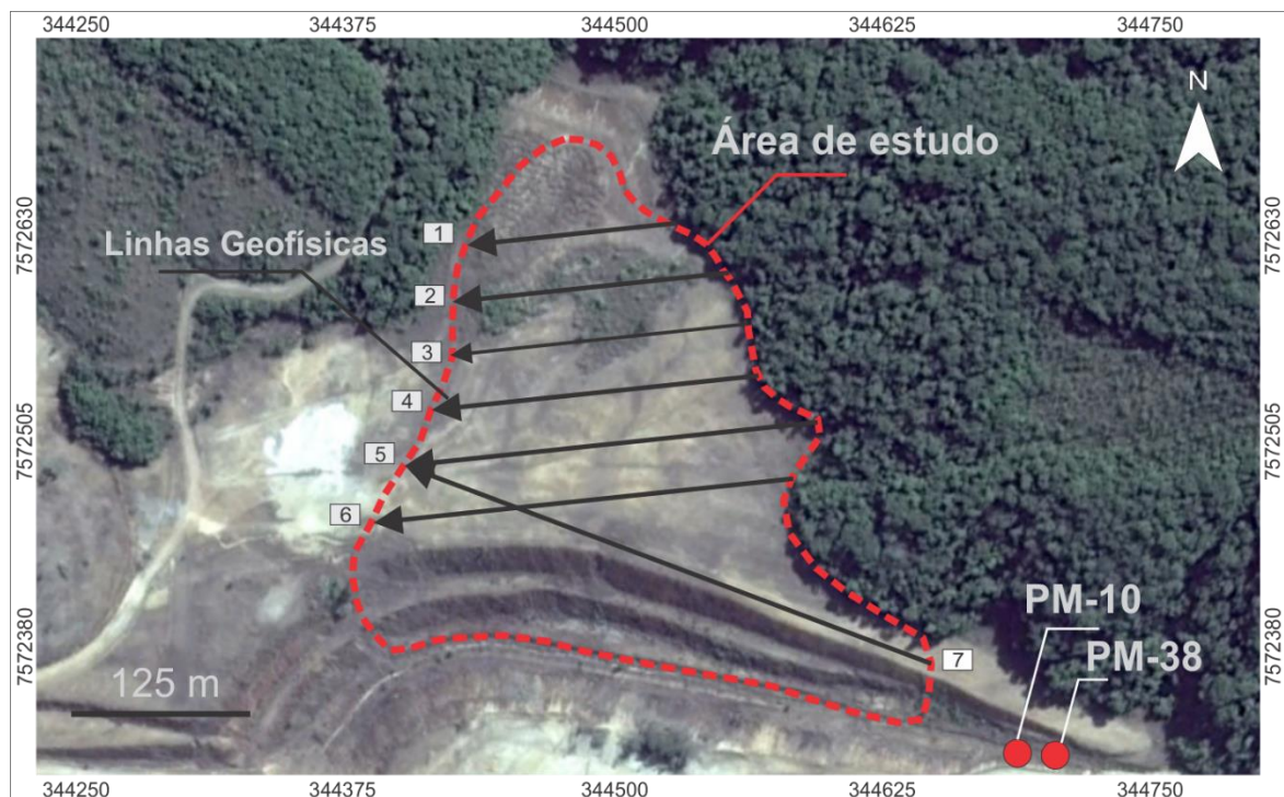
Figura 31. Disposição das linhas para aquisição dos dados geofísicos.
