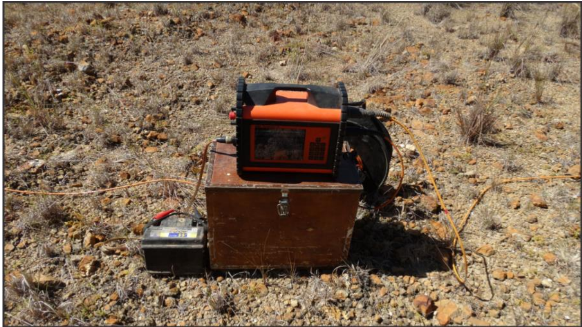
Figura 32. Terrameter LS da ABEM utilizado para aquisição dos dados geofísicos.
