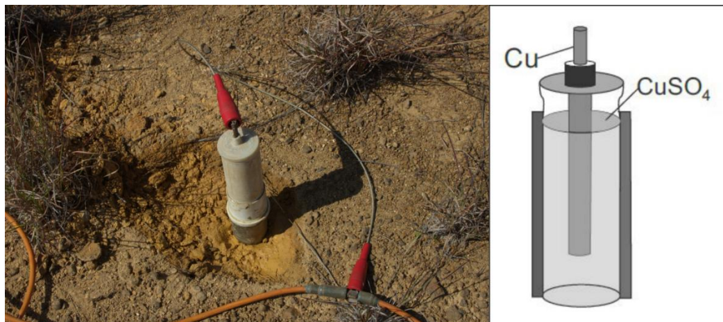
Figura 23. Esquema de eletrodo não polarizável utilizado em campo
