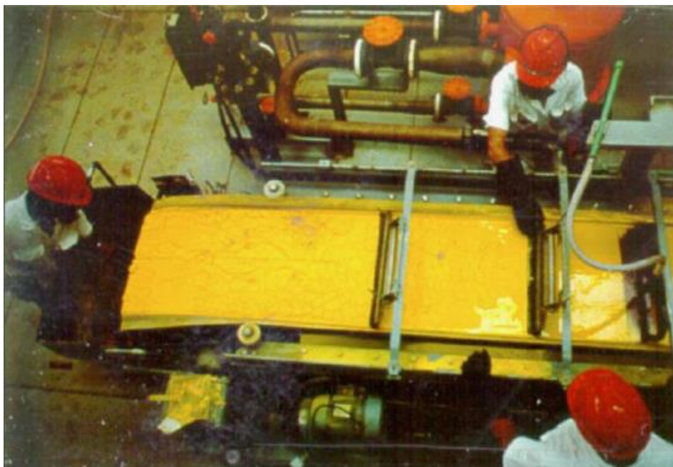
Figura 12. Produção de yellow-cake para a conformação de combustível nuclear, INB-Caldas
