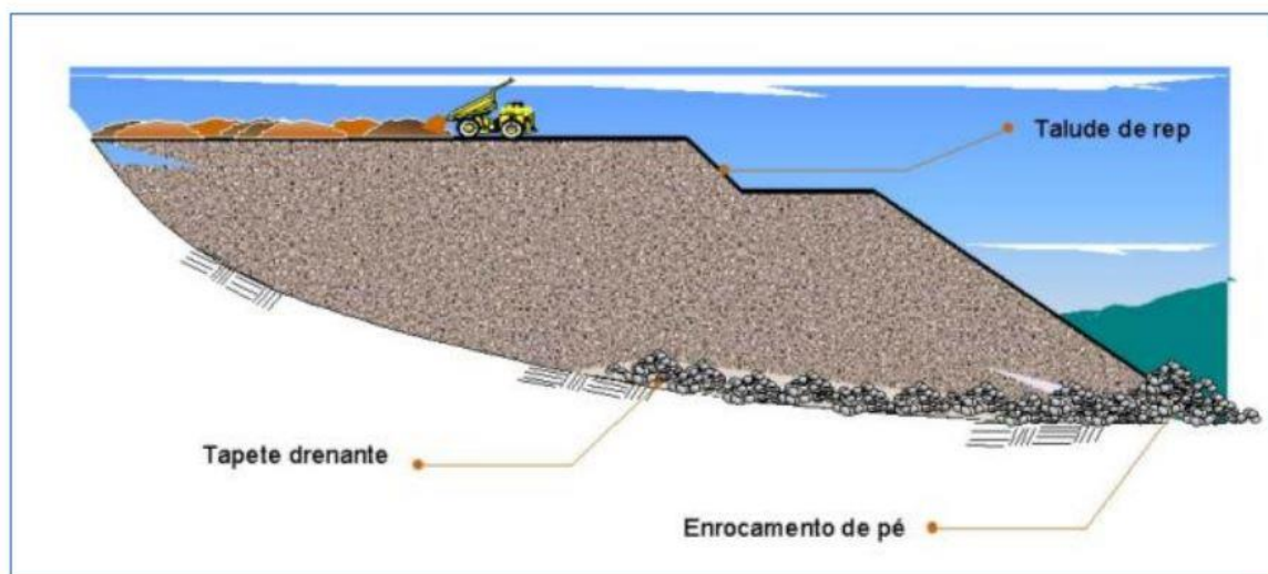
Figura 6. Geometria construtiva de pilhas de estéril pelo método de bancadas.
