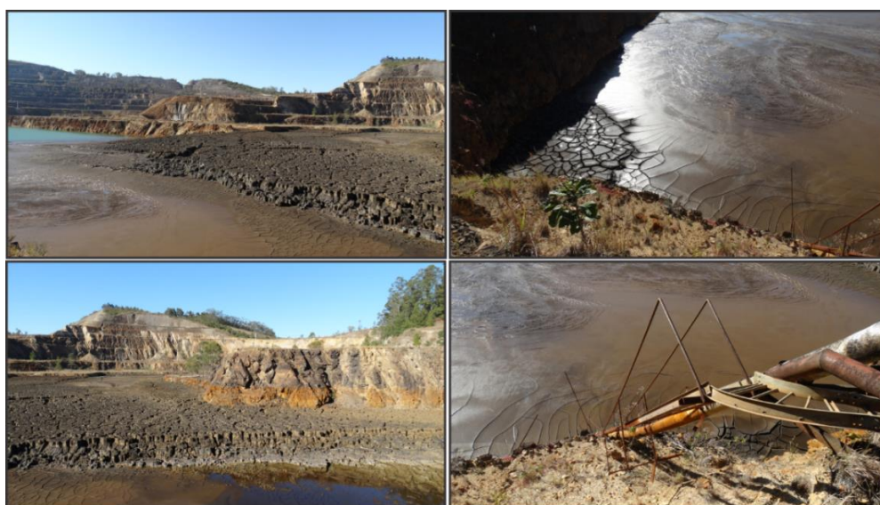
Figura 13. Descarte de lama (“DUCA”) na cava da Mina Osamu Utsumi proveniente do tratamento químico de efluentes.
