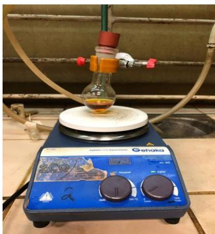
**Figura 2.** Etapa após a adição do hidróxido de amônio três vezes à solução.
