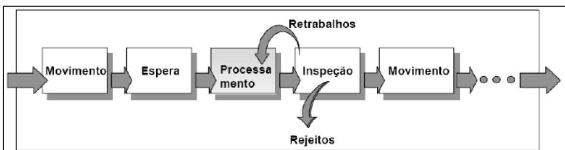
Figura 3 – Esquematização do processo produtivo proposto por Koskela, com a filosofia Lean Construction
