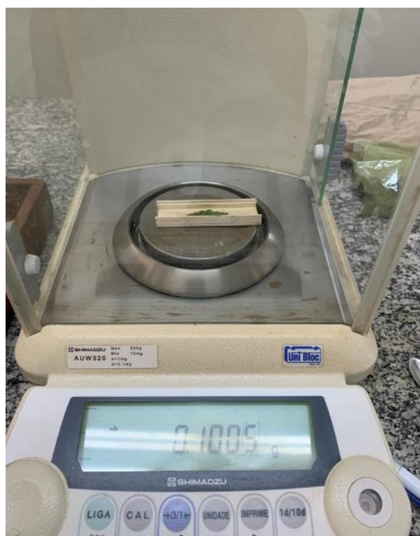
Figura 13. Pesagem das amostras para determinação dos teores nutricionais
