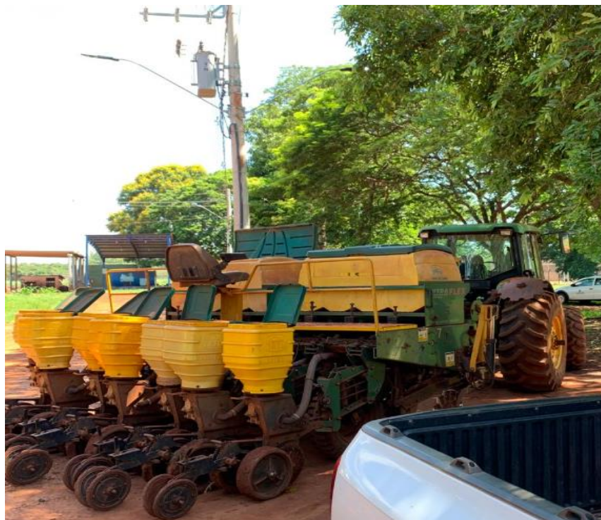
Figura 2. Semeadora-adubadora utilizada na instalação do experimento
