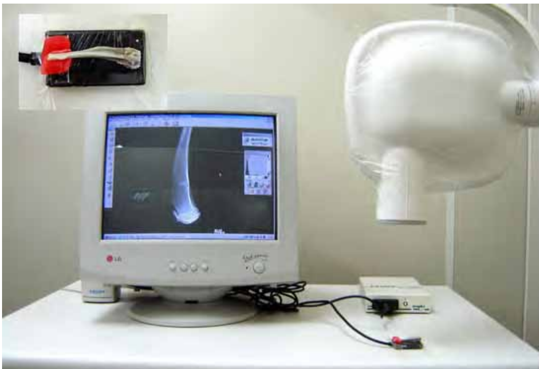
FIGURA 7 - Sistema de radiografias digitais RVGui (Trophy) e monitor do computador mostrando a imagem radiográfica digital capturada. Em detalhe, sensor CCD com a tíbia montada na posição utilizada para radiografar.
