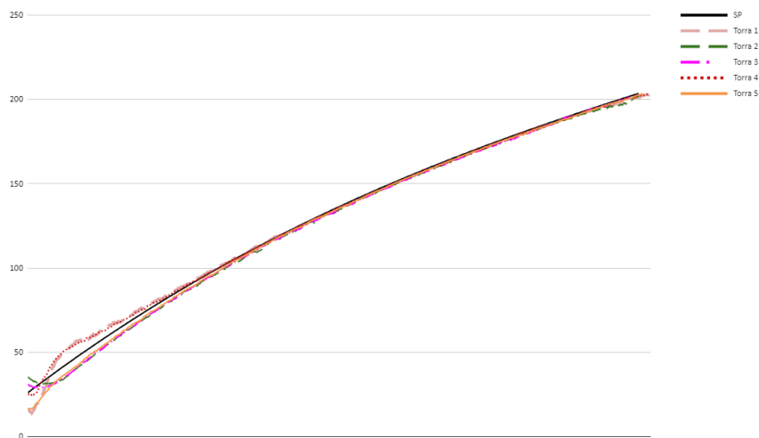
Figura 49: Curvas temperatura x tempo medidas para as 5 torras no teste de repetibilidade.
