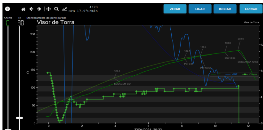
Figura 39: Resultado obtido no Artisan para o controlador proporcional.
