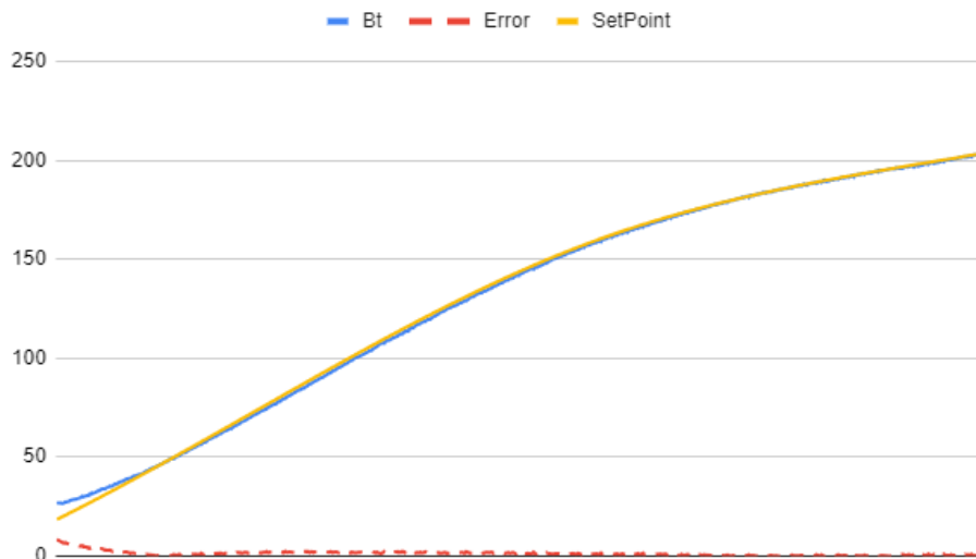
Figura 46: Curvas de setpoint , medida, e erro para o resultado com controlador PID.
