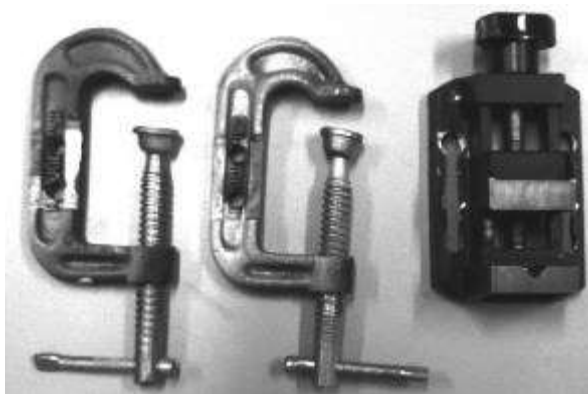
Figura 50 – Sistema de fixação: substituição da mini morsa por 2 (dois) grampos C.
