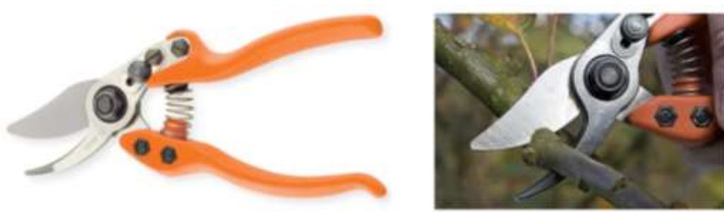
Figura 8 – Tesoura de poda do tipo bypass . Fonte: Adaptado de ORIGINALLOWE (2013b)
