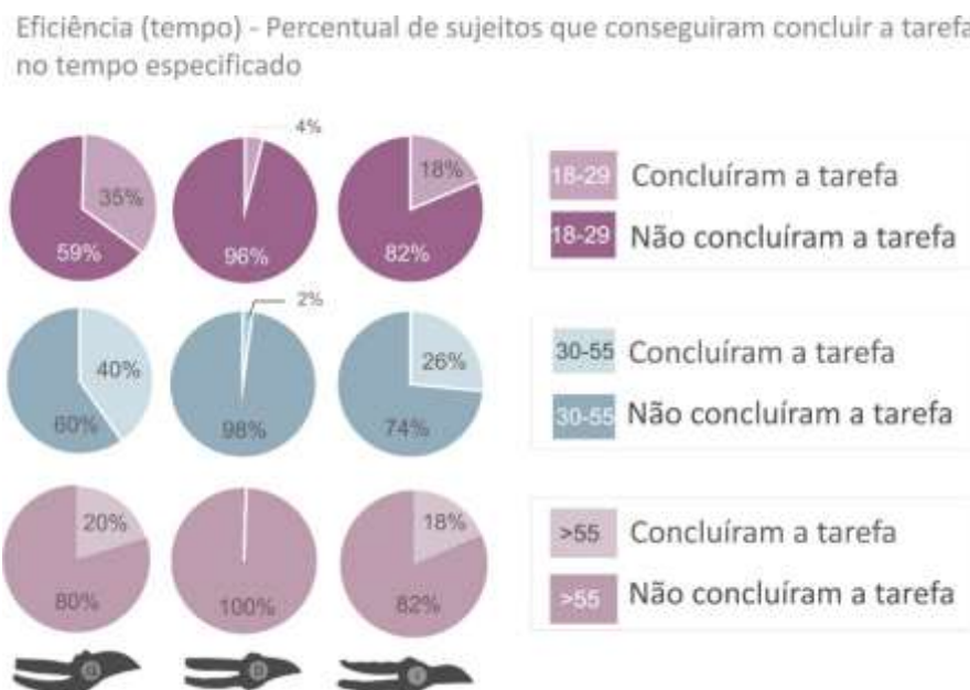
Figura 119 - Resultados quanto à eficiência das tesouras de poda considerando a diferença entre faixas etárias.
