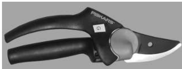
Figura 49 – Tesoura com orifício para transpasse do gancho de tração.
