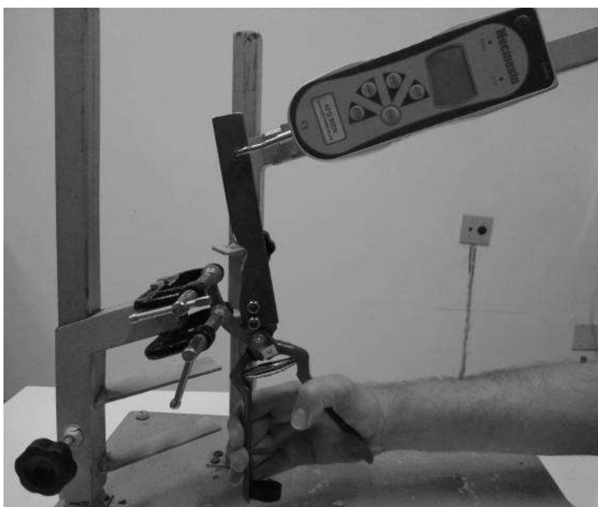
Figura 54 – Suporte para coleta de dados biomecânicos em tesouras de poda.
