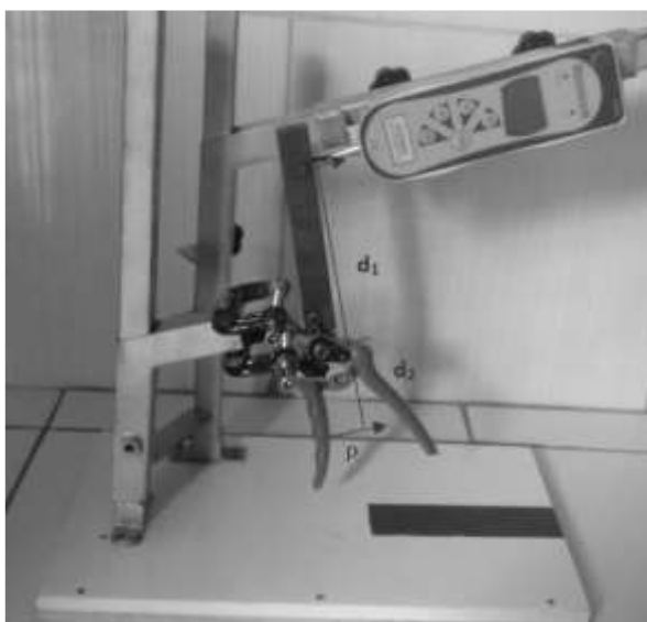
Figura 55 – Variáveis atuantes no sistema de alavanca para acionamento da tesoura de poda considerando a estratégia de coleta da presente pesquisa.
