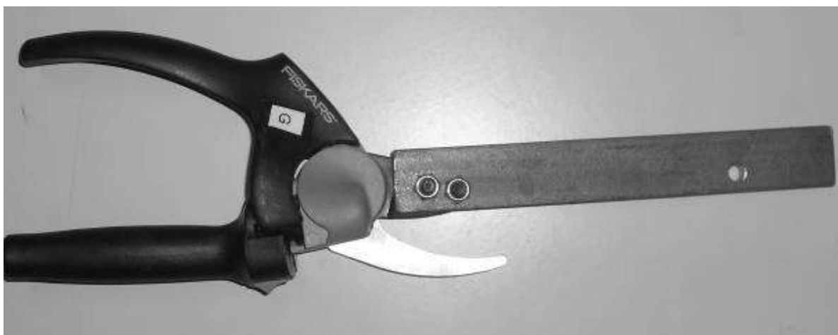
Figura 53 – Tesoura com prolongamento da distância entre o eixo e o ponto de transpasse do gancho.
