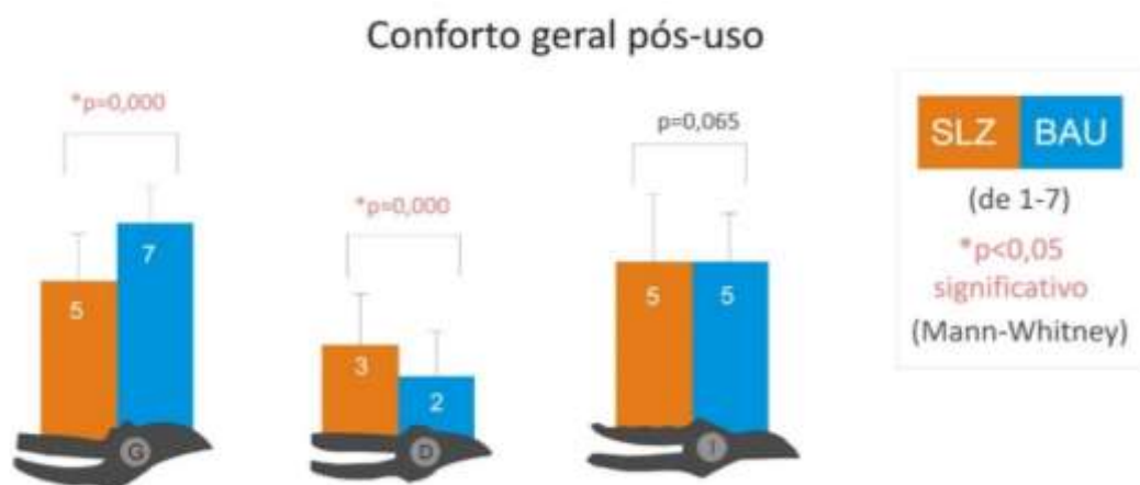
Figura 99 - Resultados gerais (médias e desvios padrão) quanto à influência da cidade na percepção do conforto (pós-uso) em tesouras de poda; e valor de “p” para o teste de Mann-Whitney. Na escala, 1 corresponde a muito desconfortável e 7 corresponde a muito desconfortável.
