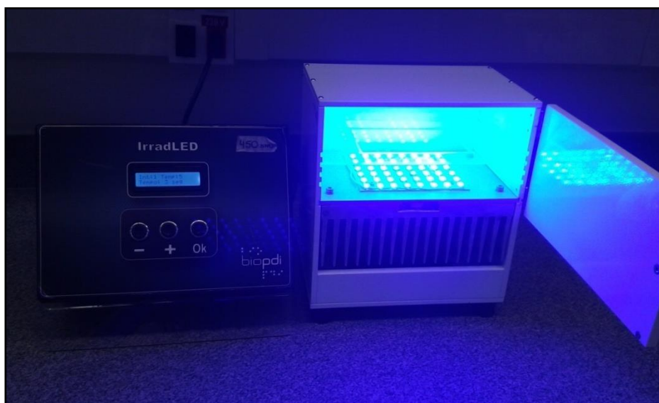
Figura 2 – Fonte de luz LED no de comprimento de onda de 450 nm.
