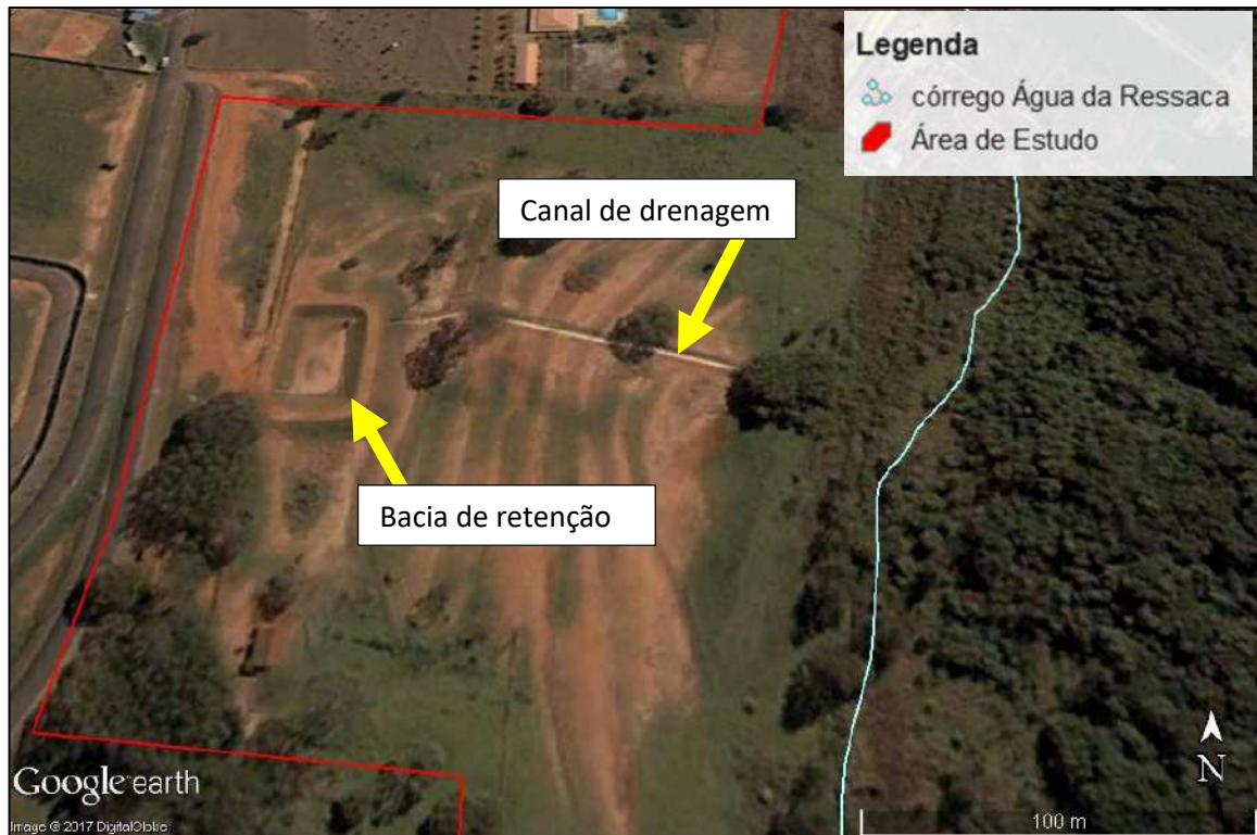
Figura 20. Imagem aérea de 2004, retratando o sistema de drenagem das águas pluviais.
