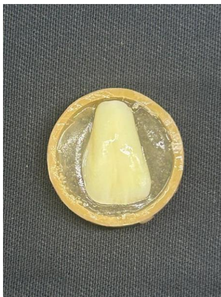
Figura 2 – Amostra de dente bovino fixado em anel de tubo de PVC
