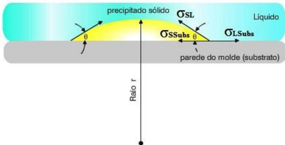
Figura 15: Representação da formação de um núcleo heterogêneo sobre uma superfície plana e horizontal.
