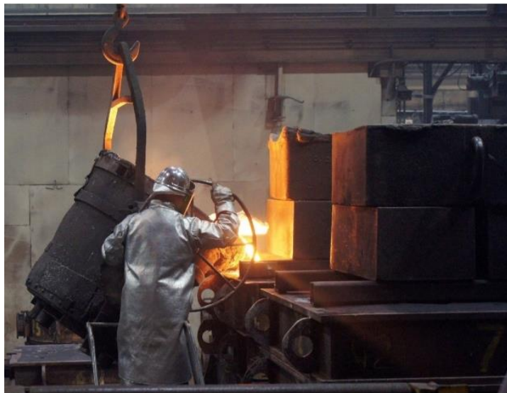
Figura 1: Processo de fundição utilizando moldes de areia base e aglomerantes.
