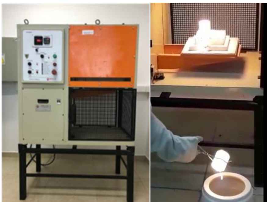
Figura 44: Forno de fusão com máximo de temperatura de 1700 °C
