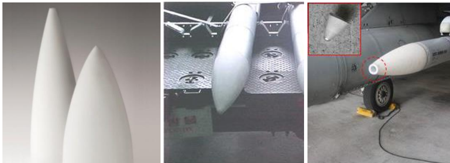
Figura 36: Cúpula de mísseis de material vitrocerâmico
