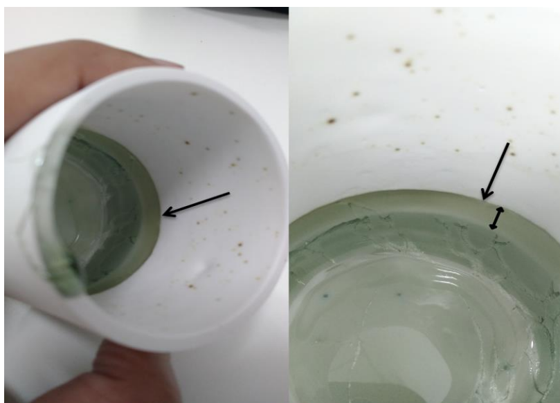
Figura 45: Corrosão do cadinho de alumina durante a fusão das misturas
