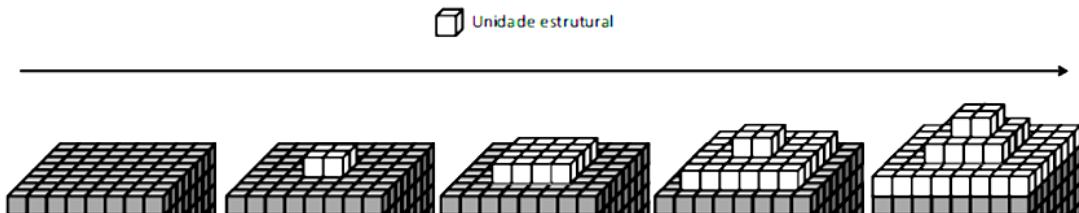
Figura 26: Representação, esquemática, do crescimento por Nucleação Superficial Secundária (polinúcleos).
