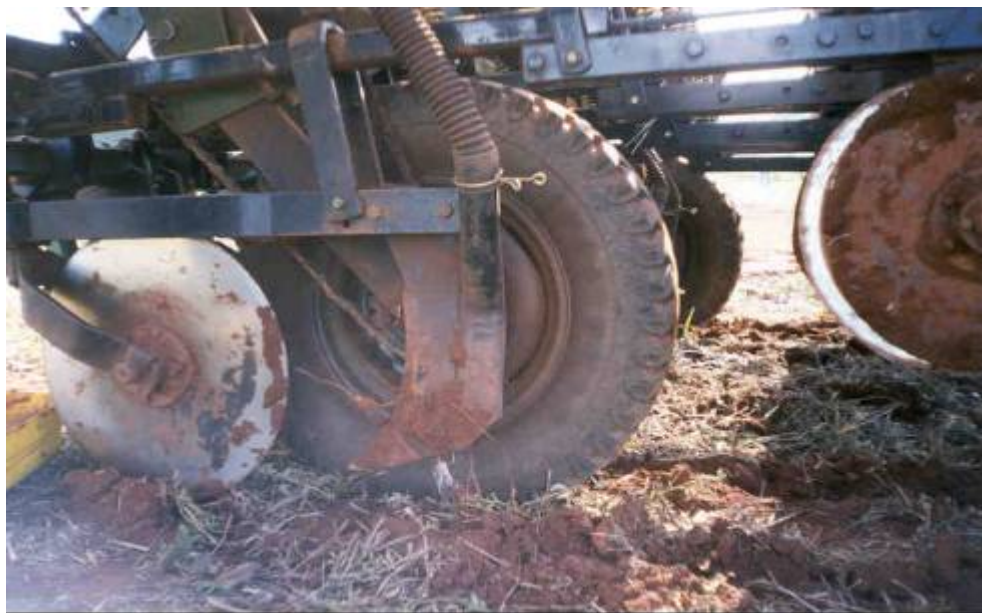
Figura 5. Haste sulcadora utilizada na semeadora-adubadora para deposição de fertilizante.
