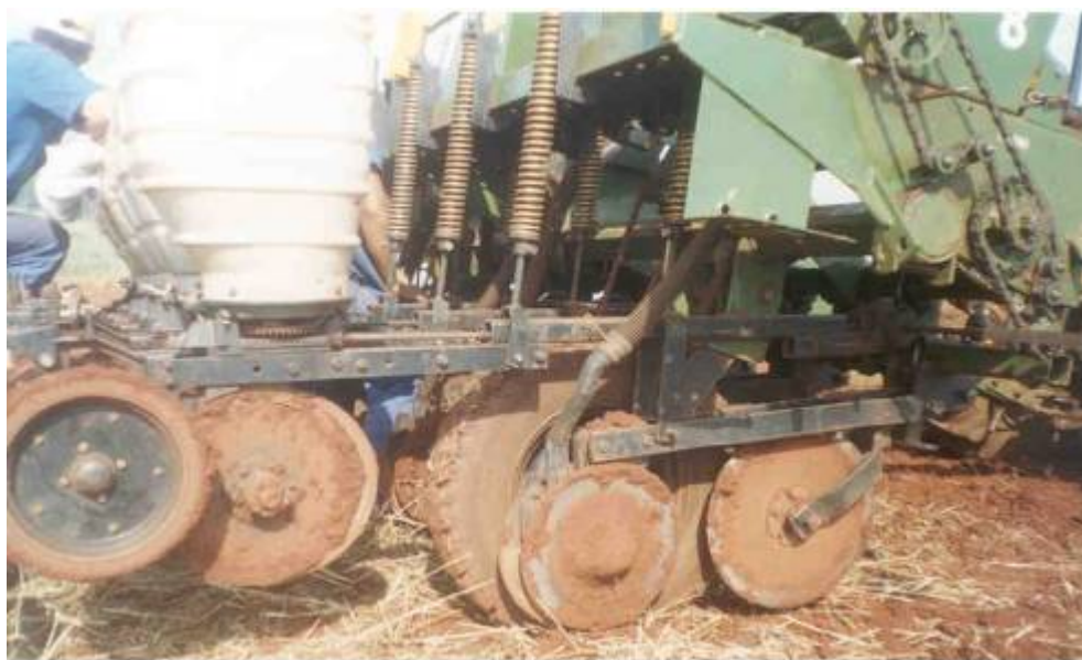
Figura 6. Disco duplo desencontrado utilizado na semeadora-adubadora para deposição de fertilizante.
