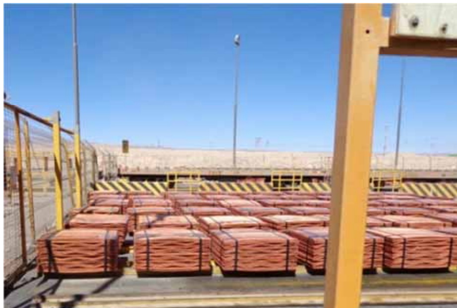
Figura 3 – Imagens dos catodos de cobre obtidos após os processos de extração na Mina Spence em Antofagasta (Chile).
