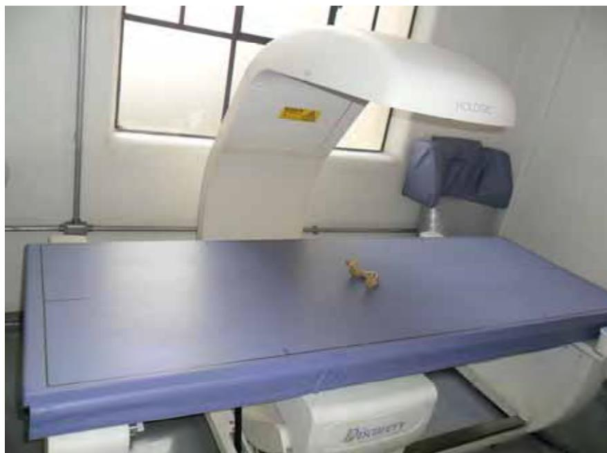
Figura 6 – Mandíbula posicionada no aparelho de absorciometria.
