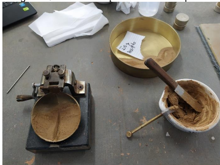
Figura 13 – Determinação do limite de liquidez.
