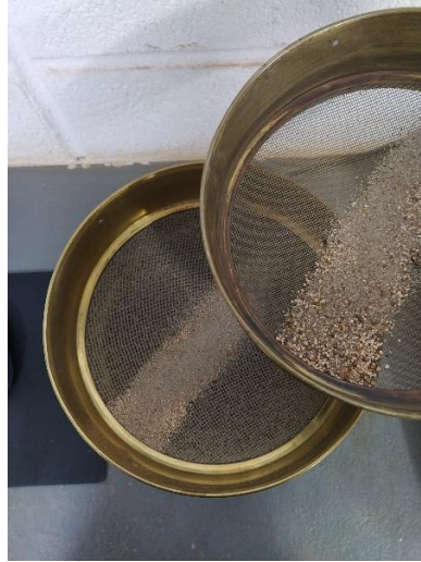
Figura 12 – Peneiras durante o ensaio de peneiramento fino.
