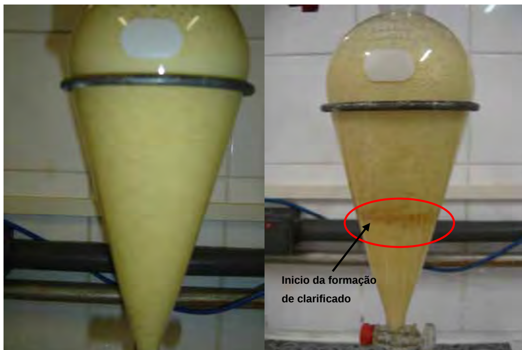
FIGURA 18 – Ensaio à pressão de 290 kPa, mostrando separação de fases após 20 minutos (funil de separação à esquerda) e com 40 minutos de flotação (à direita)
