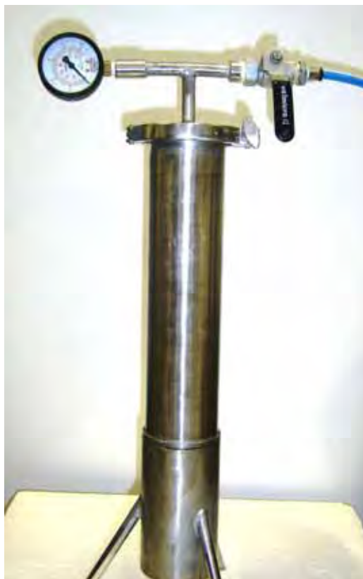
FIGURA 13 – Fotografia do flotador de bancada usado nos experimentos
