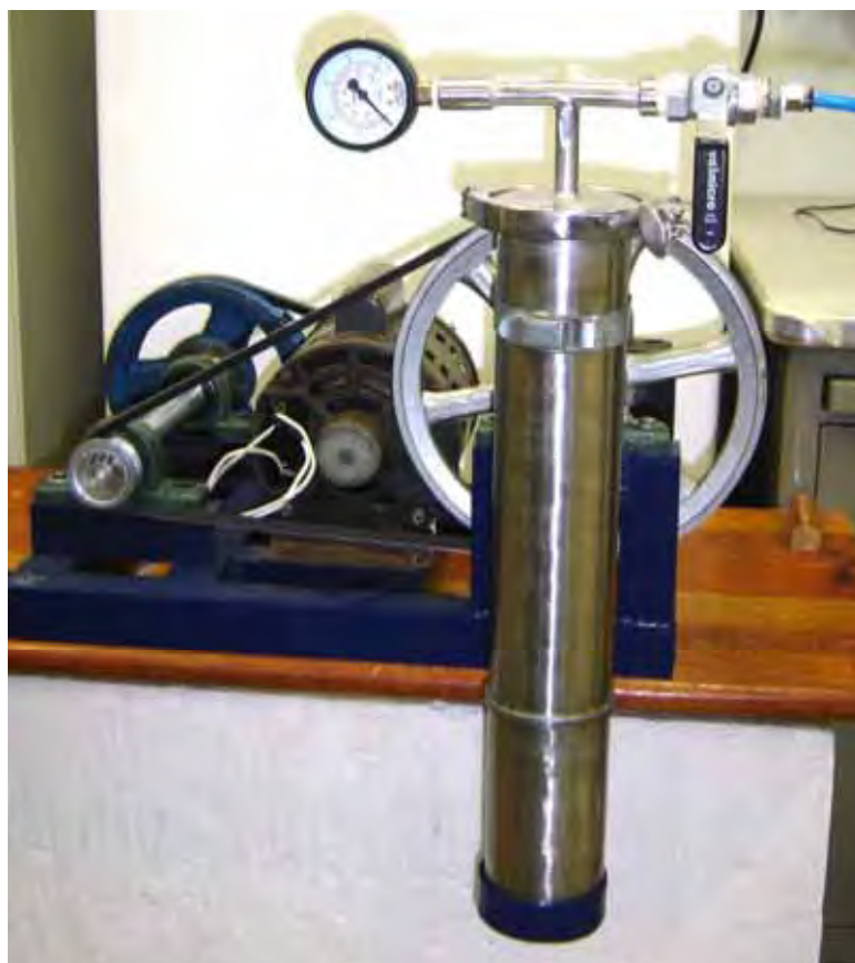
FIGURA 14 - Fotografia do agitador com o flotador acoplado
