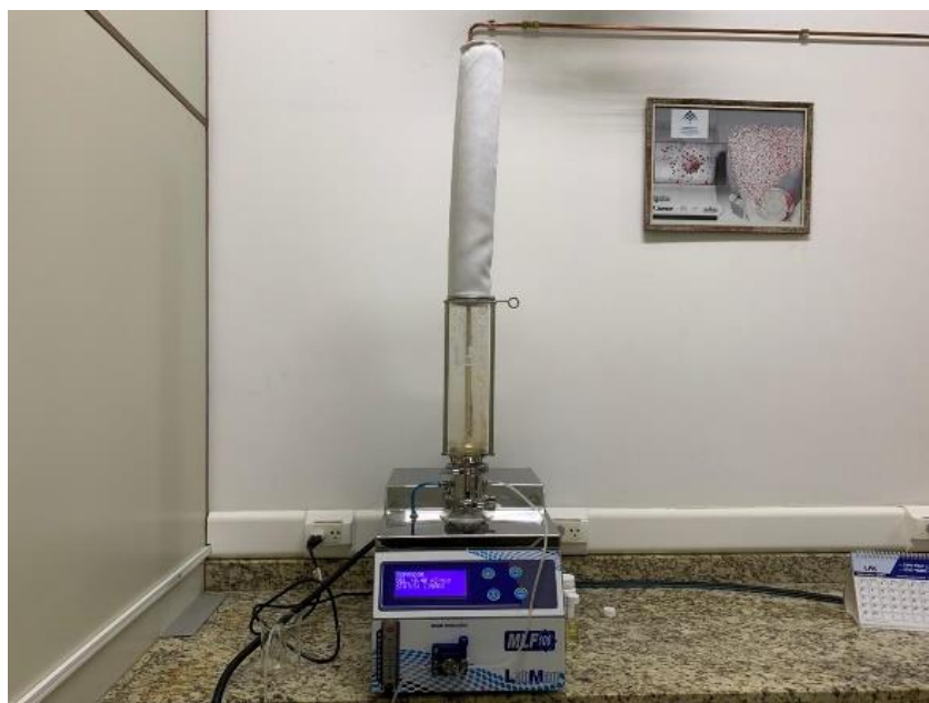
Figura 3. Processo de revestimento das micropartículas do peptídeo antimicrobiano Ctx(Ile 21 )-Ha, através de leito fluidizado.
