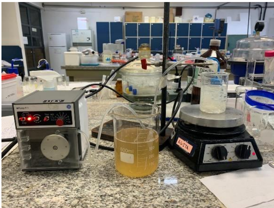
Figura 2. Processo de microencapsulação do peptídeo Ctx(Ile 21 )-Ha com bomba peristáltica por meio de gelificação ionotrópica.
