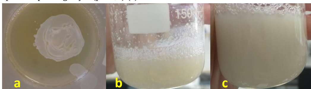
Figura A1: F1 - formação de grumos ao adicionar-se ácido acético à solução de isolado protéico de soja (a) grumos na parede do béquer (b) solução já sem grumos após completa agitação (pH 7,0) (c).
