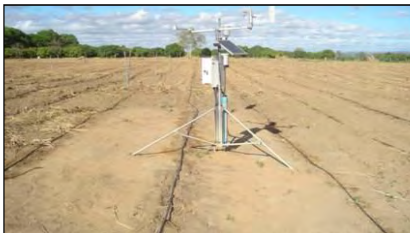
Figura 6. Estação agrometeorológica automática instalada no centro da área experimental.
