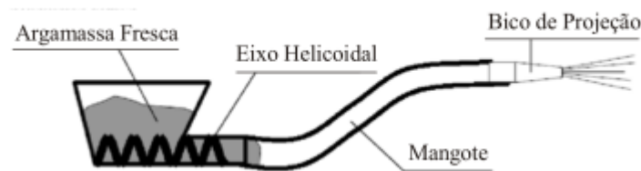
Figura 23: Bomba de eixo helicoidal.
