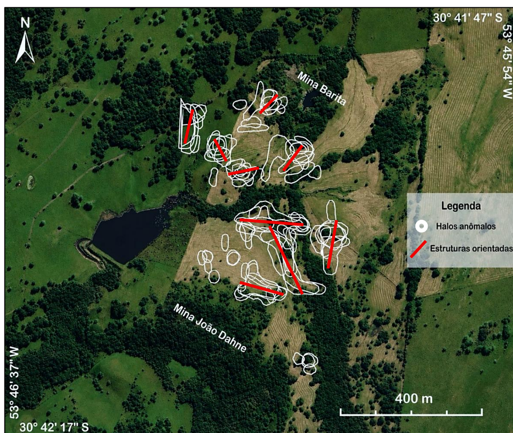
Figura 21. Mapa de sobreposição, com os resultados existentes nos halos anômalos (valores altos) dos mapas 2D processados com todos os filtros de realce. Os alvos de interesse são estruturas nas direções \pm NE-SW, \pm E-W e \pm NW-SE, concentradas na posição central e distribuídas na região entre a área das duas minas.
