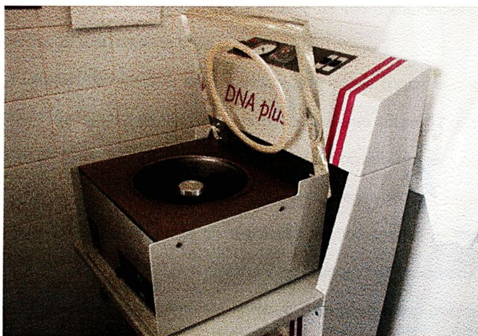
Figura 9. Equipamento utilizado para a remoção dos resíduos de TFA após a hidrólise do polissacarídeo.
