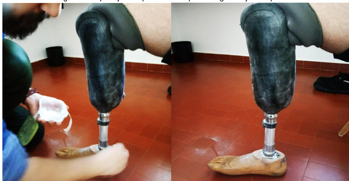
Figura 25: Aplicação do pó revelador para a digitalização da prótese
