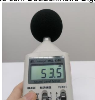
Figura 61: Controle Acústico com Decibelímetro Digital Minipa MSL 1350.
