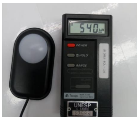
Figura 60: Controle de Iluminação com Luxímetro Digital MINIPA MLM - 1332.
