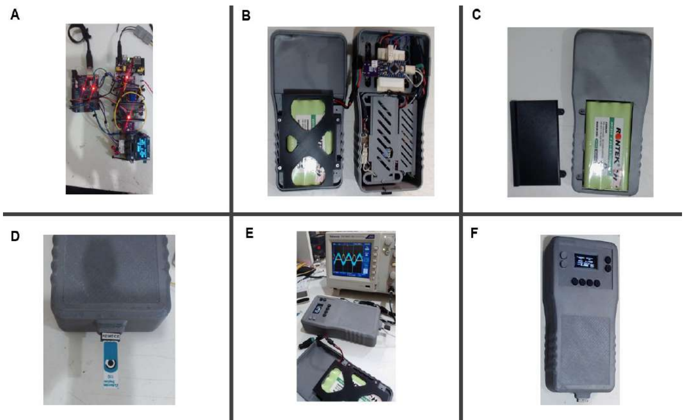
Figura 8. Fotografias de algumas etapas do desenvolvimento do dispositivo. A) Circuitos elétricos em fase de teste, B) adaptação para a caixa impressa, C) encaixe da bateria, D) local para inserção do eletrodo impresso, E) teste de sinal/ruído no osciloscópio, F) equipamento final.
