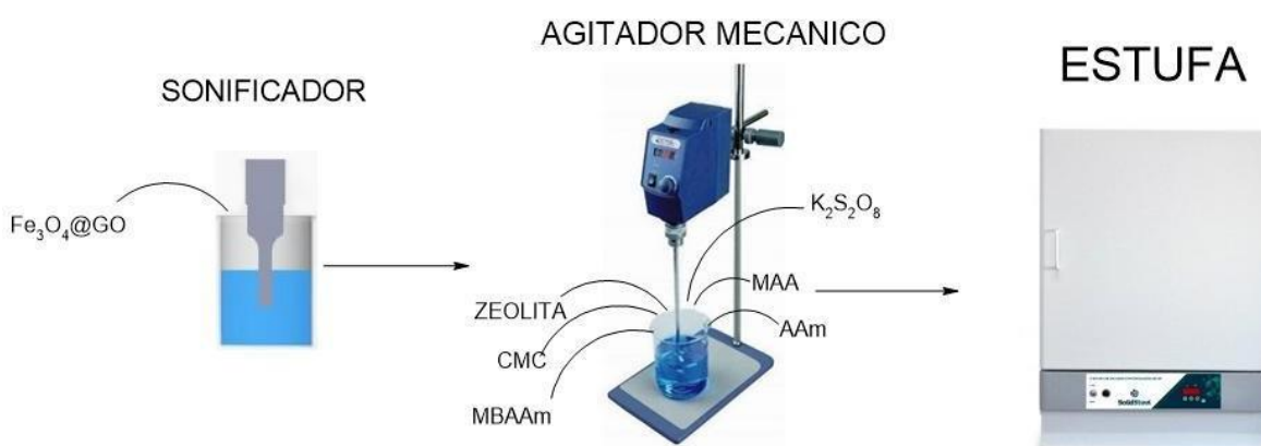
Figura 11: Etapas de síntese do hidrogel nanocompósito.
