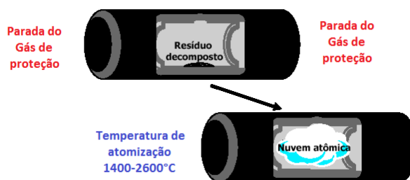
Figura 2.4 – Etapa de atomização da amostra no programa de aquecimento para determinação por GFAAS.
