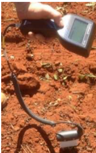
Figura 16. Determinação do teor de água do solo utilizando Reflectometria no Domínio do Tempo (TDR).
