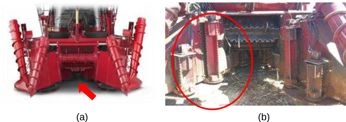
Figura 23. Colhedoras de Cana Case IH A8800 Multirow sem os rolos verticais – Tratamento 1 (a) e com os rolos verticais – Tratamento 2 (b).
