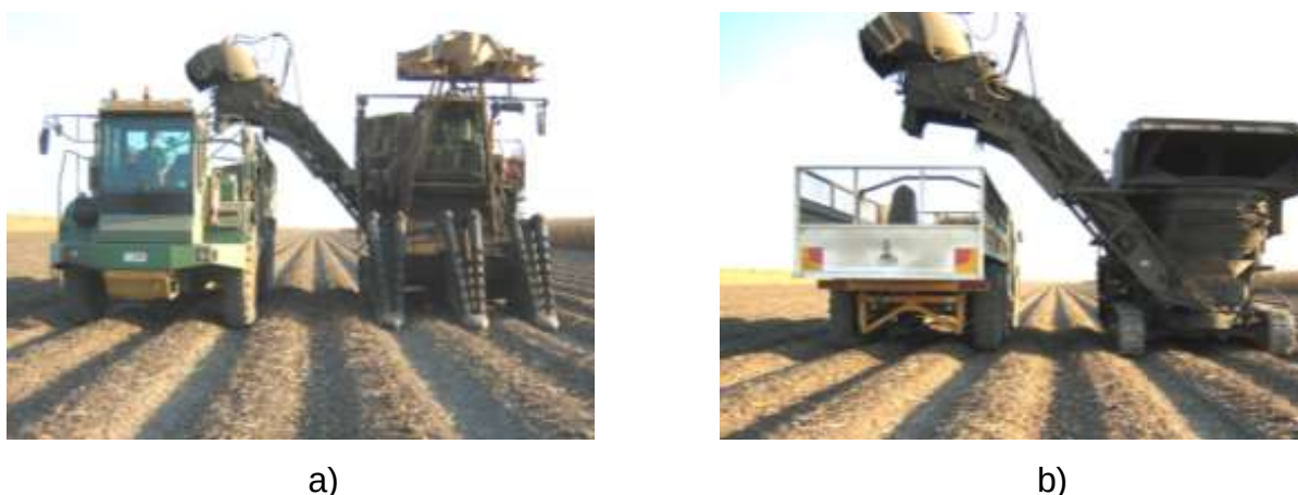
Figura 9. Disposição de equipamentos (bitola de 3,0 m) na colheita mecanizada de duas fileiras em espaçamento simples (1,50 m): a) Vista frontal; b) Vista traseira.
