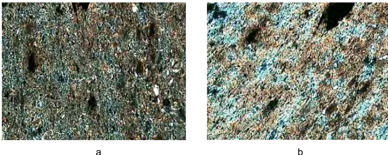
Figura 30 - Birrefringência da matriz illítica observada ao rotacionar a platina 45° da posição a para b (nicois cruzados).
