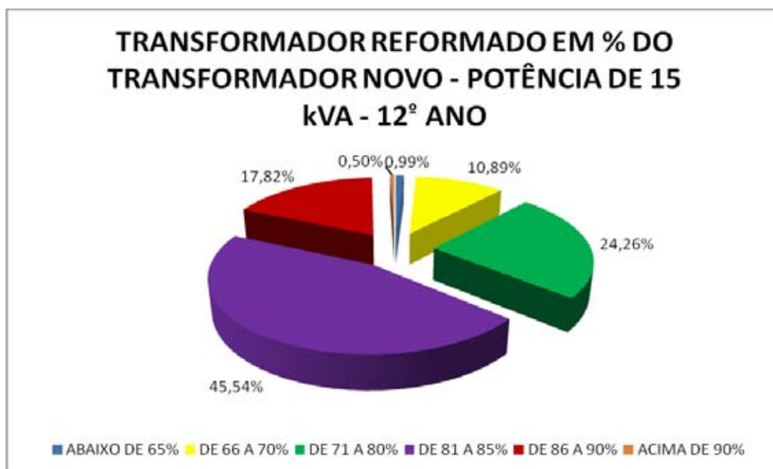
Figura 5.33: Transformadores reformado versus transformador novo – 15 kVA – 12º ano.
