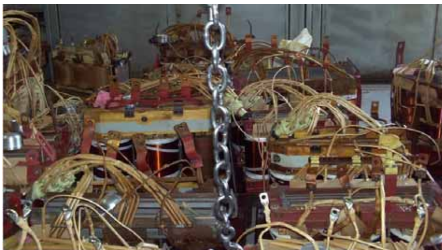
Figura 4.15: Vista de dentro da estufa com vários núcleos em processo de secagem.
