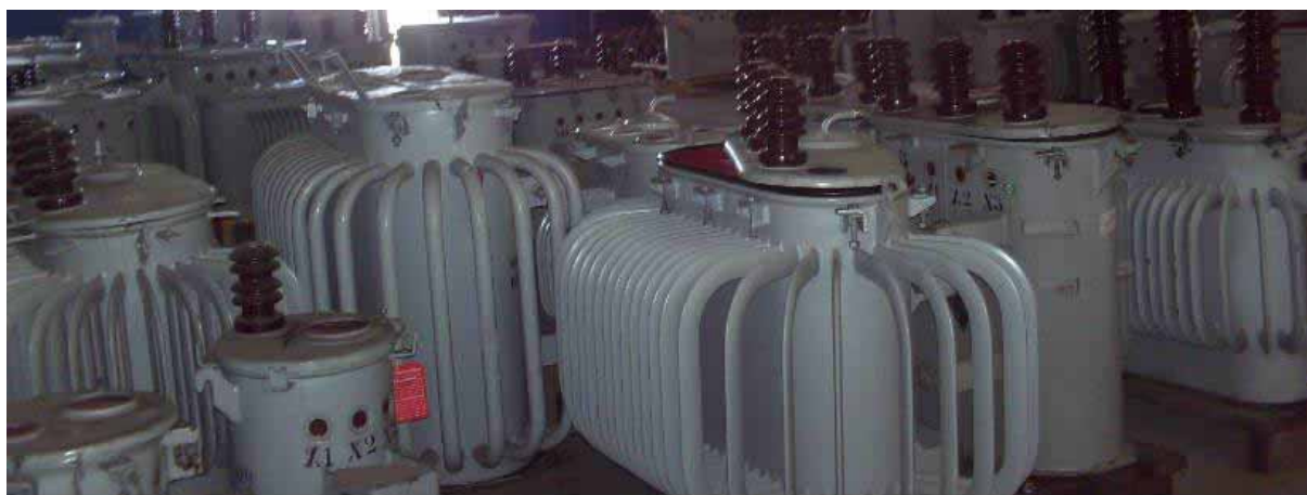
Figura 4.17: Tanques de transformadores fabricados pela reformadora.
