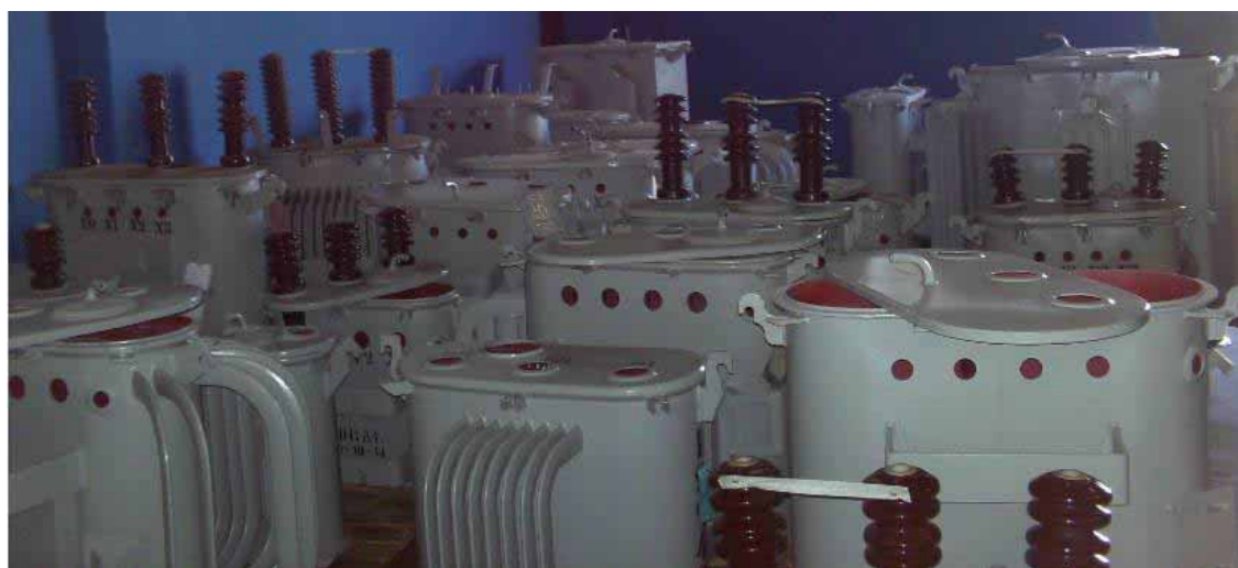
Figura 4.18: Tanques de transformadores fabricados pela reformadora.
