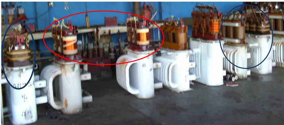
Figura 4.12: Enrolamentos novos em vermelho e usados em azul.
