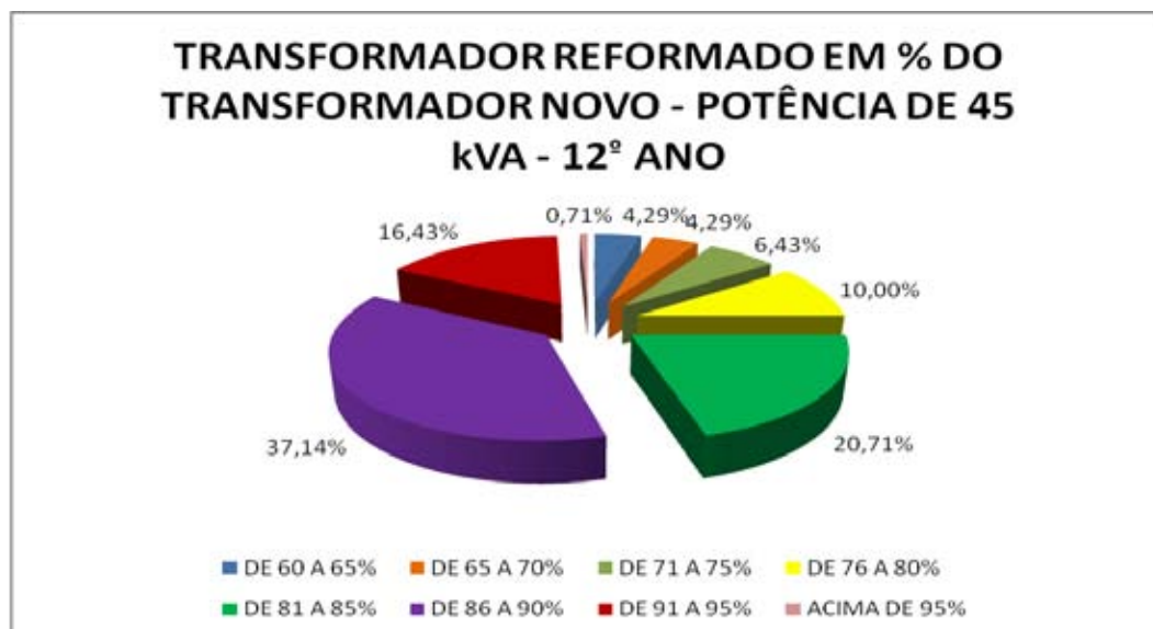
Figura 5.37: Transformadores reformado versus transformador novo – 45 kVA – 12º ano.
