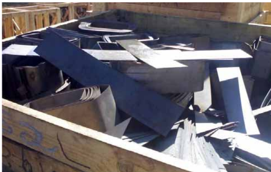
Figura 6.4: Sucata de aço com detalhe das lâminas do núcleo.
