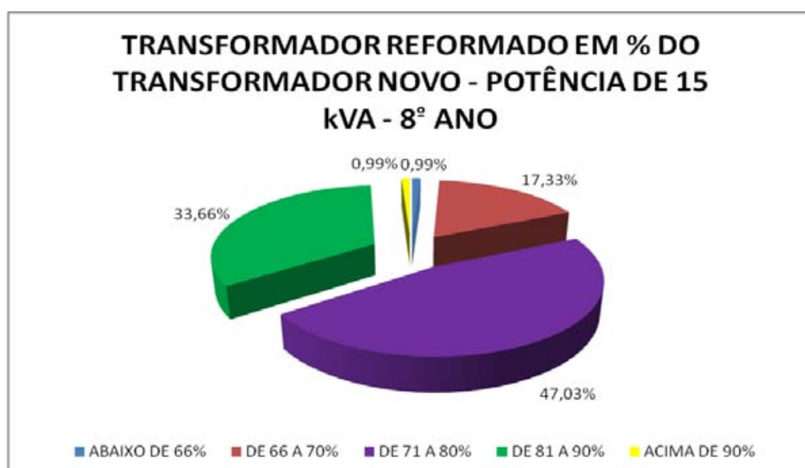
Figura 5.32: Transformadores reformado versus transformador novo – 15 kVA – 8º ano.
