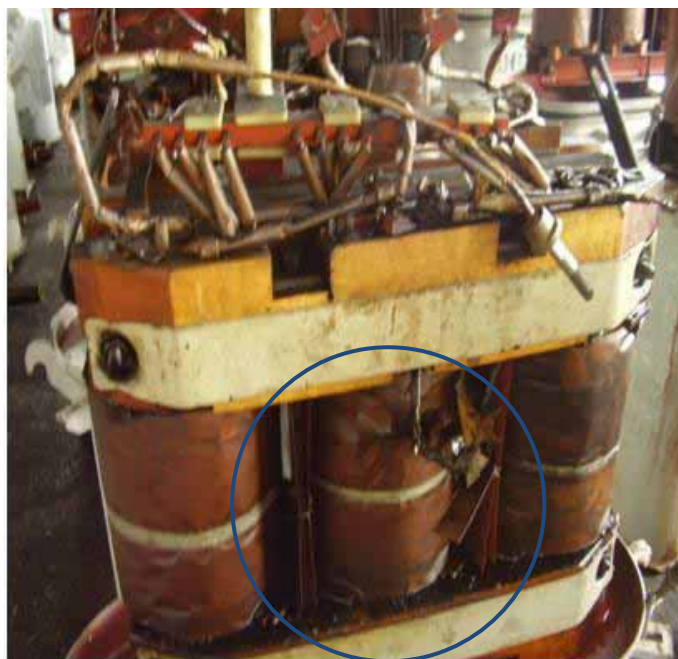
Figura 4.7: Transformador com a fase C danificada por descarga atmosférica.
