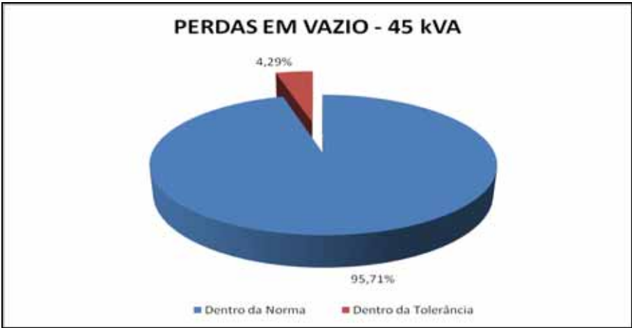
Figura 5.16: Perdas em vazio para os 140 transformadores de 45 kVA.
