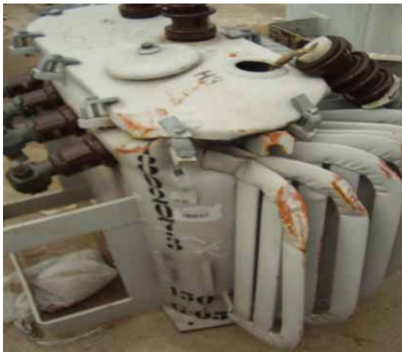
Figura 4.9: Transformador totalmente danificado por manuseio inadequado.
