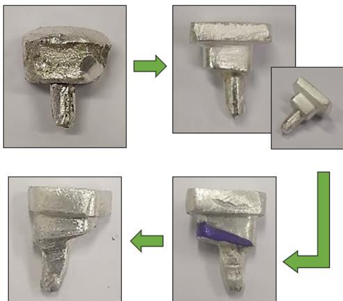
Figura 49 - Processo de ajustagem da Interface de Prata I
