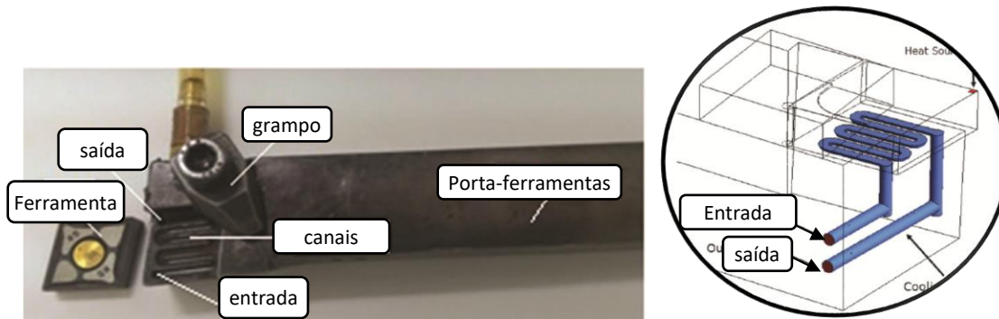
Figura 17 - Porta-ferramentas com canais internos de Isik et al. (2017).
