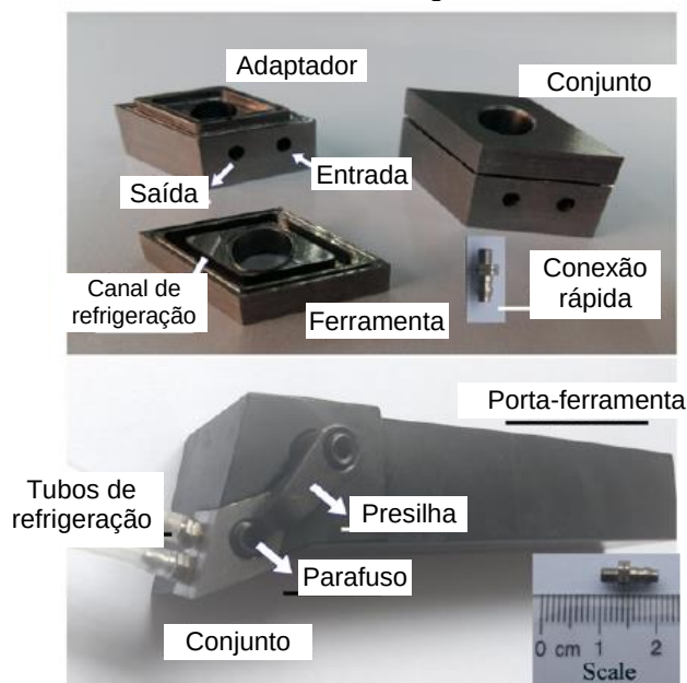
Figura 27 - Ferramenta Modular Internamente Refrigerada desenvolvido por Wu et al. (2018).
