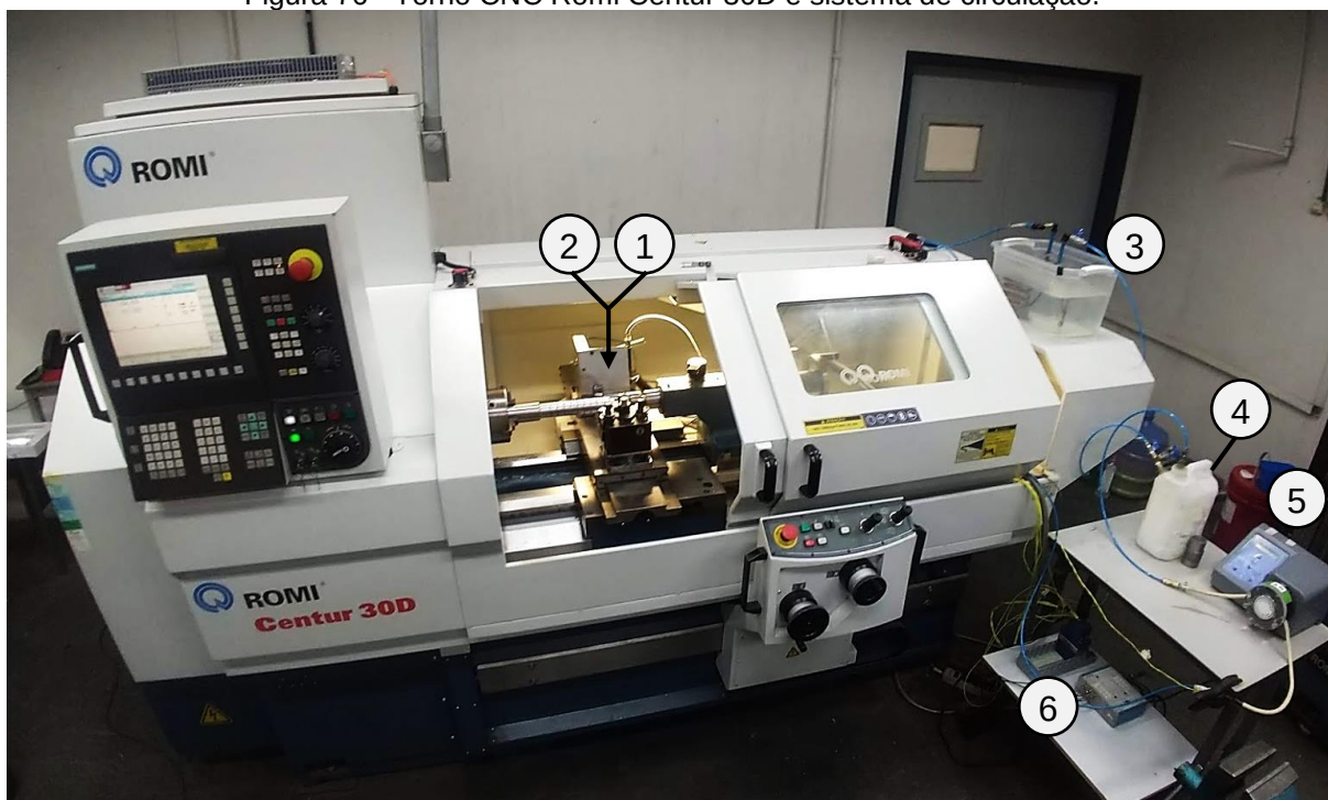
Figura 76 - Torno CNC Romi Centur 30D e sistema de circulação.
