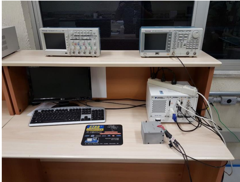
Figura 36 - Fotografia do sistema de medição de resistividade pelo método quatro pontas desenvolvido no LabVIEW .
