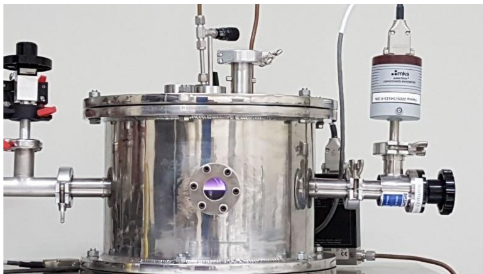
Figura 33 - Fotografia do reator de plasma no momento da aplicação do filme de AZO por FAP magnetron sputtering.
